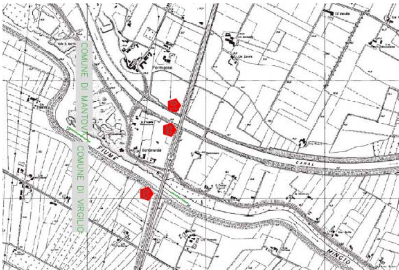
Figura 10.5 – Ubicazione sondaggi canale Fissero-Tartaro e fiume Mincio
