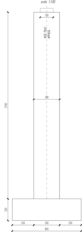
Pila P2 - Sezione trasversale
