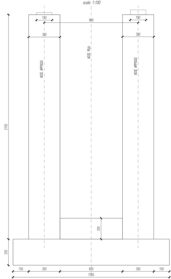
Pila P1 - Sezione longitudinale
