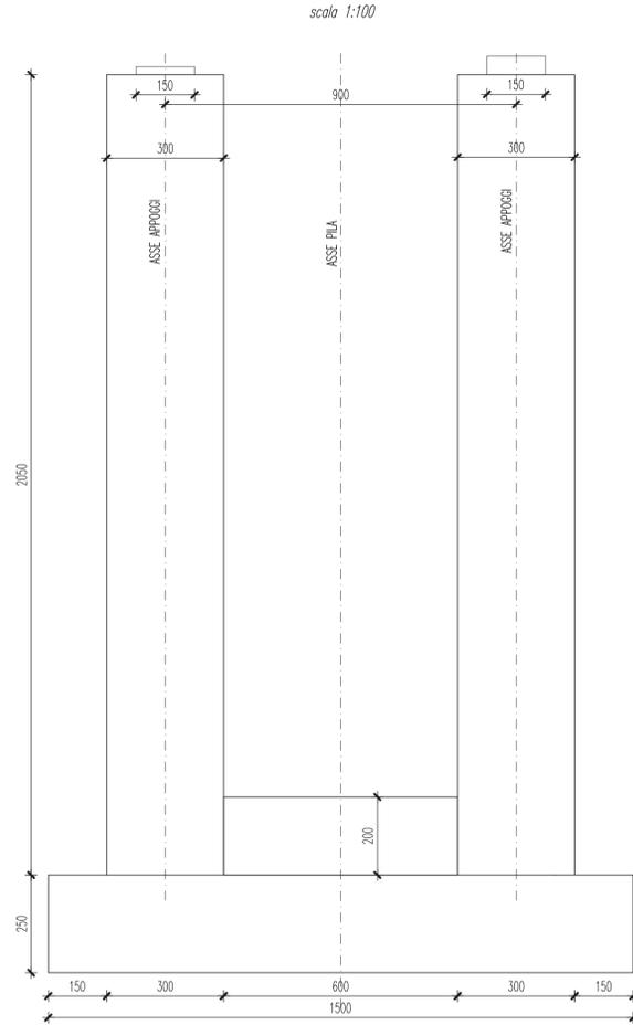
Pila P2 - Sezione longitudinale
