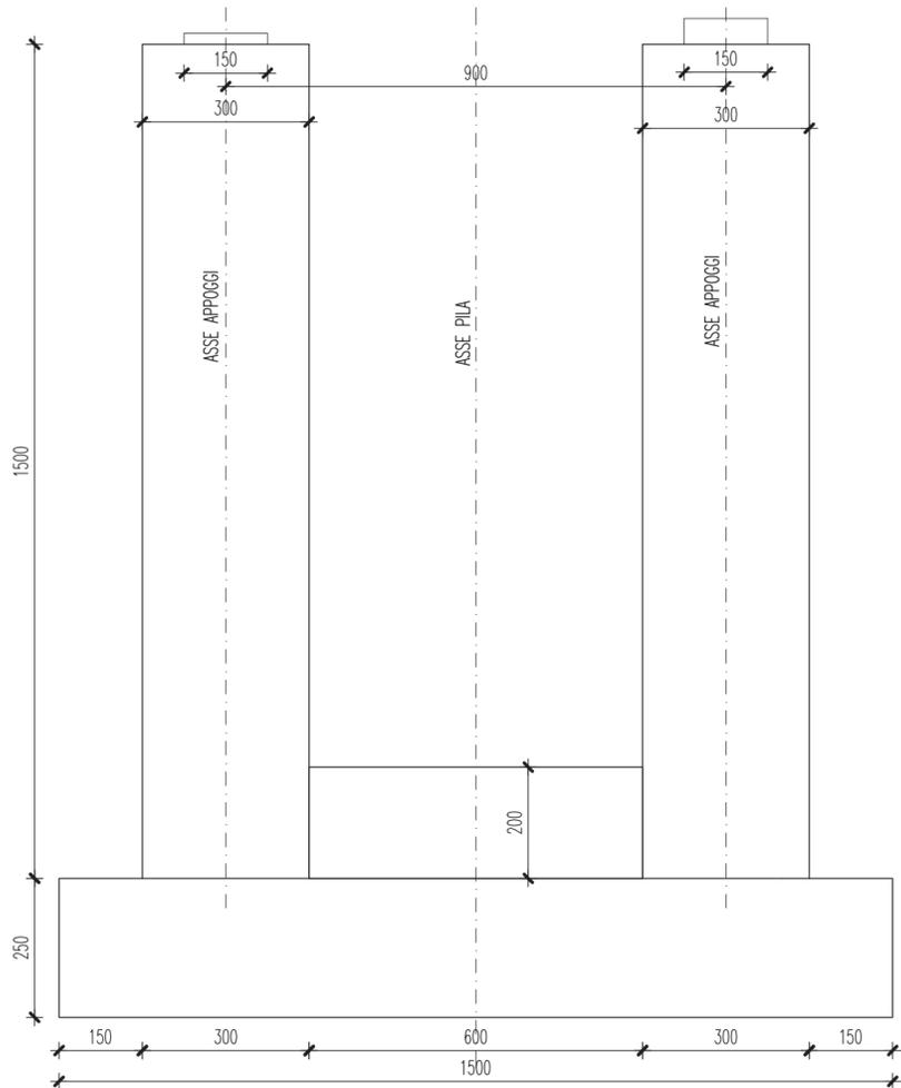
Pila P7 - Sezione longitudinale
