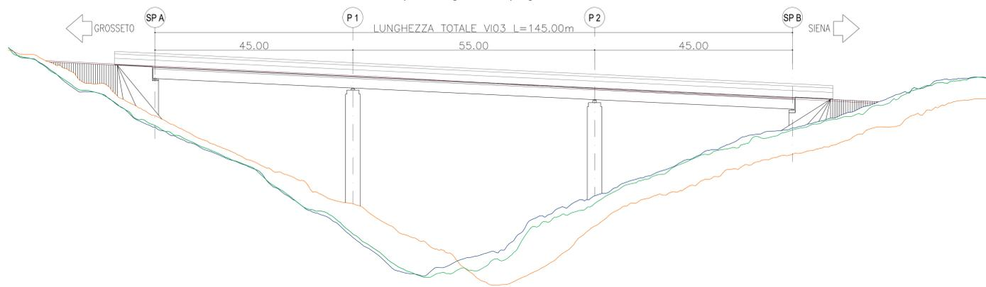
VI03 - Prospetto longitudinale progetto di variante
