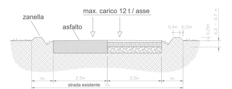
Sezione stradale tipo in scavo
