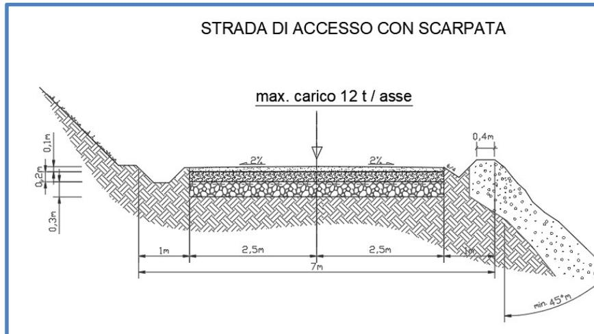
**Figura 6 - Sezione stradale tipo a mezza costa**
