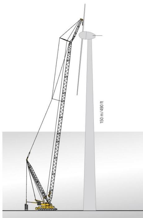
Figura 5.10 – Schema di una gru cingolata a traliccio con sistema derrick impiegata per l’innalzamento delle turbine eoliche dell’ultima generazione
