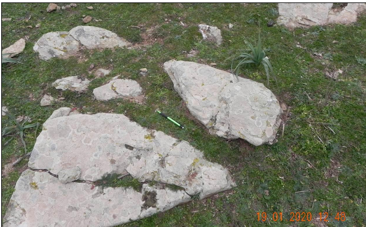
Foto 3.6 – Dettaglio della roccia d'imposta della fondazione.
