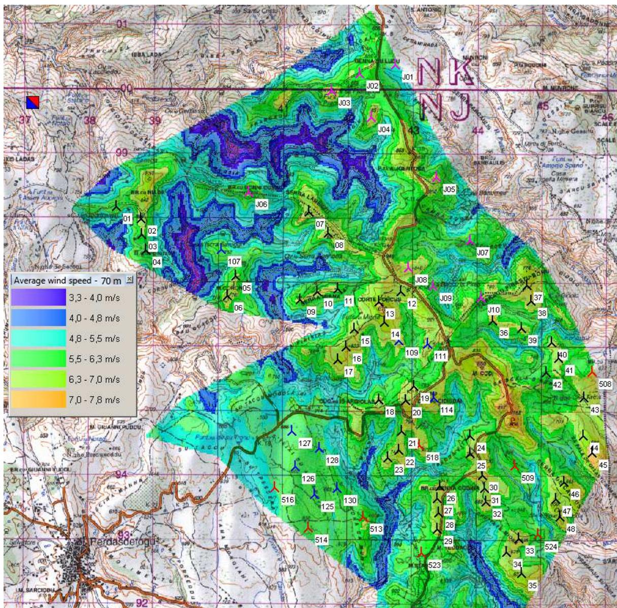
Figura 3: Mappa della risorsa eolica del sito - layout dell'impianto Abbila proposto (▲), dell'impianto Boreas sottoposto a VIA (▲), dell'impianto esistente di Ulassai in corso di reblading (▲), dell'impianto esistente Maistu (▲).
