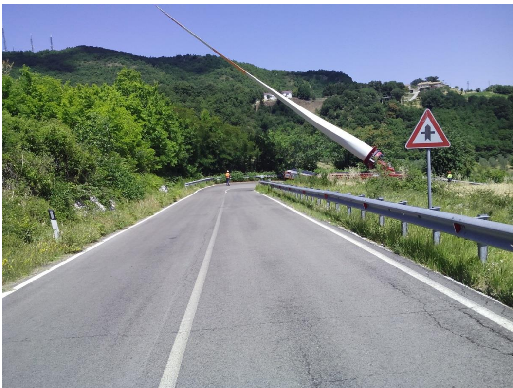
Figura 4 - Mezzo con dispositivo “alza pala” trainato da motrice: in alto su strada rurale e vegetazione arborea a bordo strada; in basso, in corrispondenza di un tornante su viabilità principale
