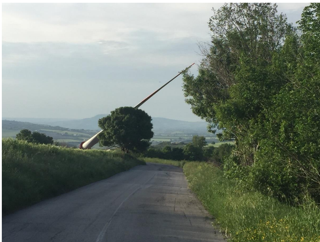
Figura 3 – Mezzo con dispositivo “alza pala” a trazione propria in un contesto di strada rurale
