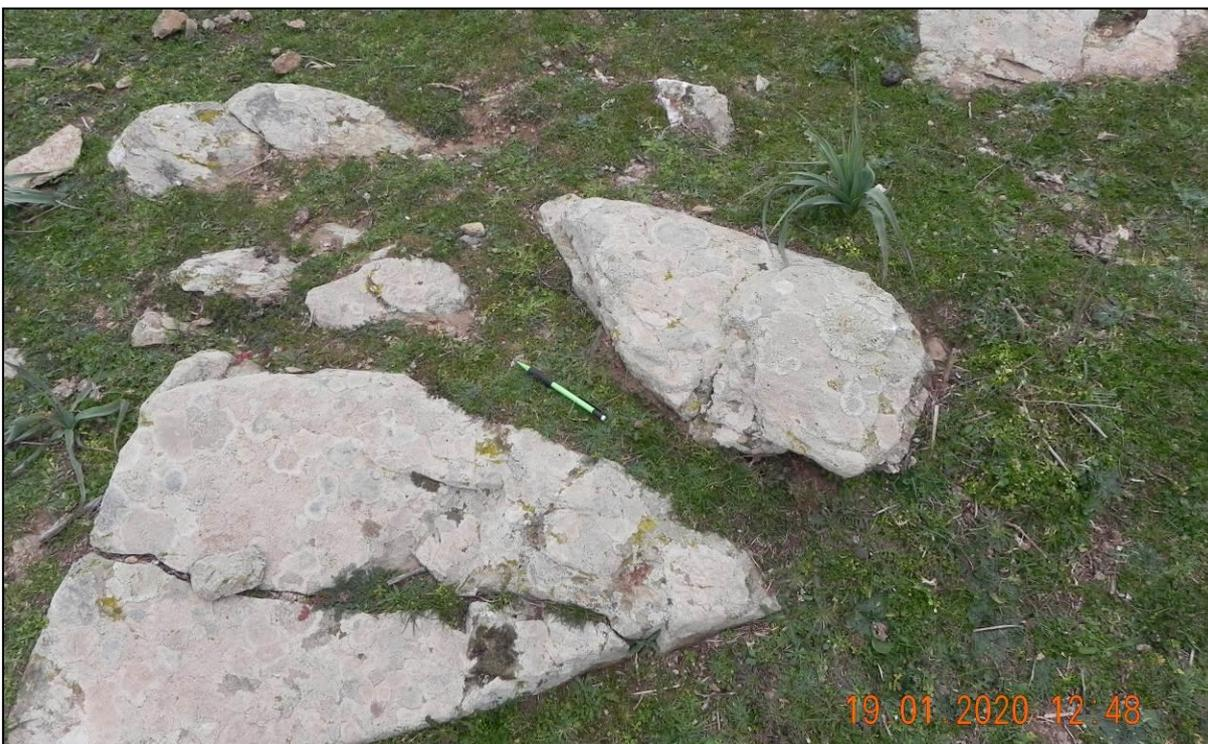
Foto 4.7 – Dettaglio della roccia d'imposta della fondazione
