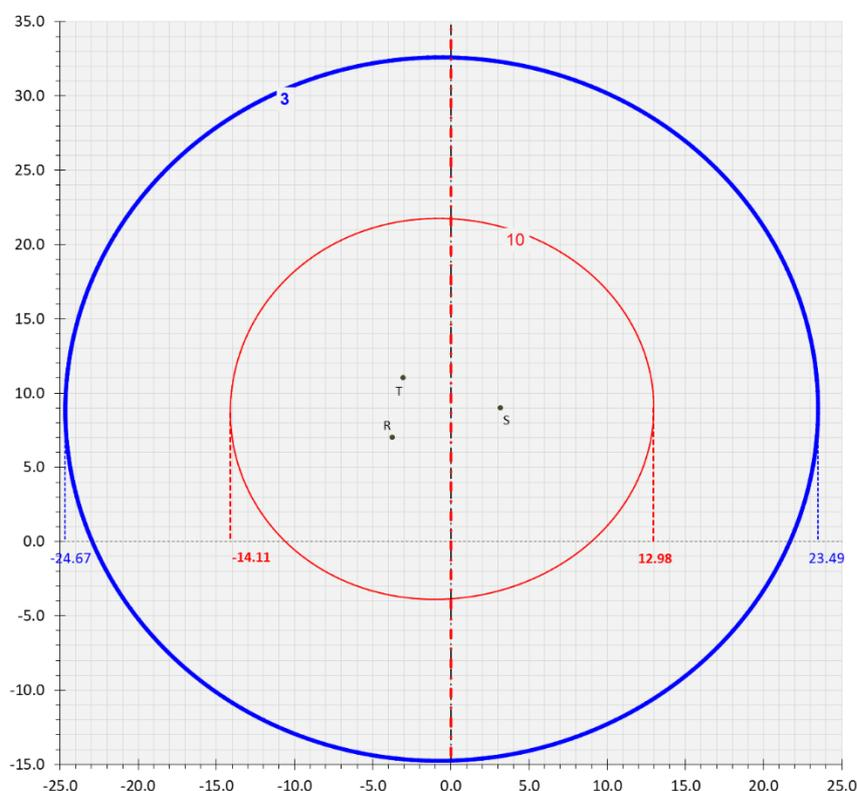
**Isolinee dell'induzione magnetica nel caso di sostegno unificato**
