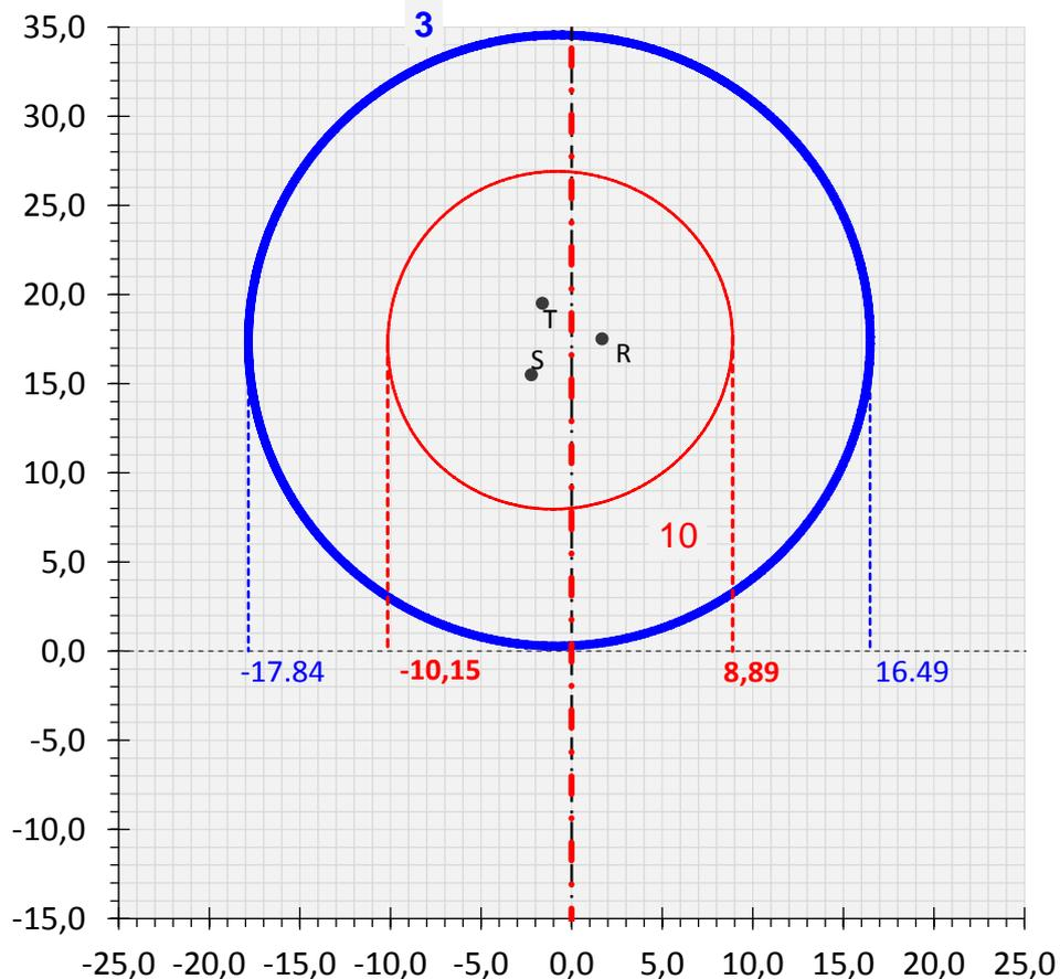
**Isolinee dell'induzione magnetica nel caso di sostegno con catene di isolatori a V**
