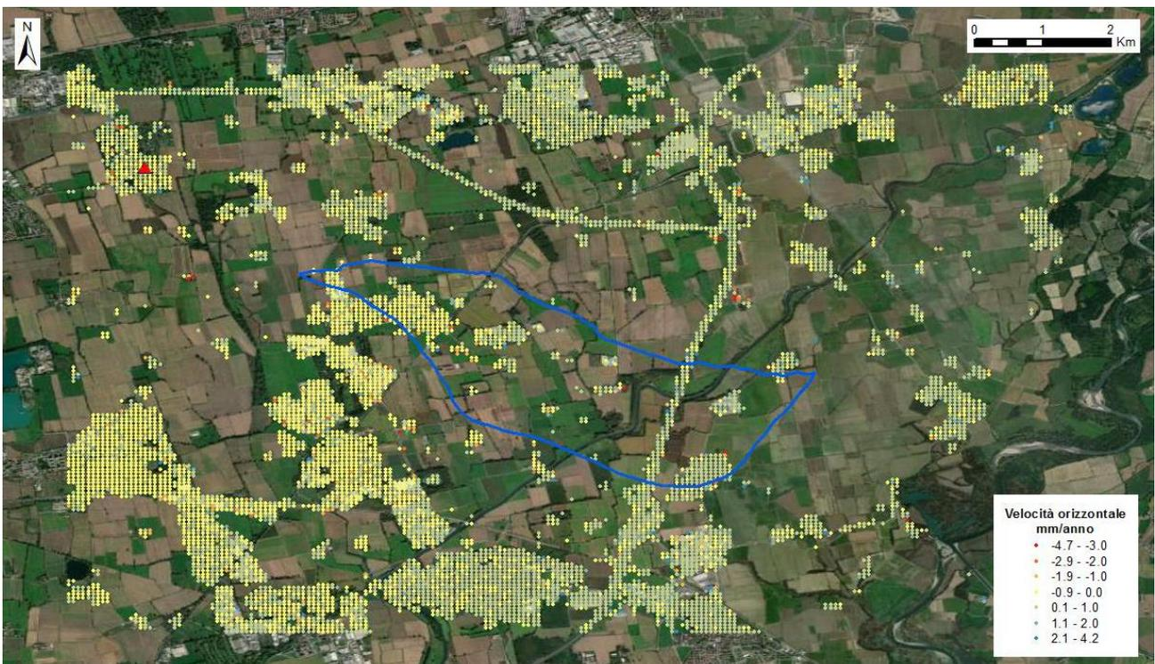
Fig. 35 *Dati Local scomposti secondo il vettore orizzontale. In evidenza il punto di riferimento utilizzato per la scomposizione del vettore velocità (triangolo rosso).*
