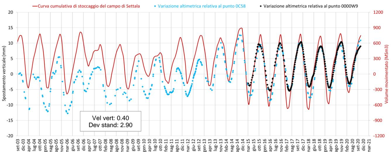
Fig. 39 Confronto tra l'andamento temporale delle variazioni altimetriche dei punti scomposti 0C58 (Radarsat) e 0000W9 (Sentinel), e la curva cumulativa di stoccaggio del giacimento di Settala.
