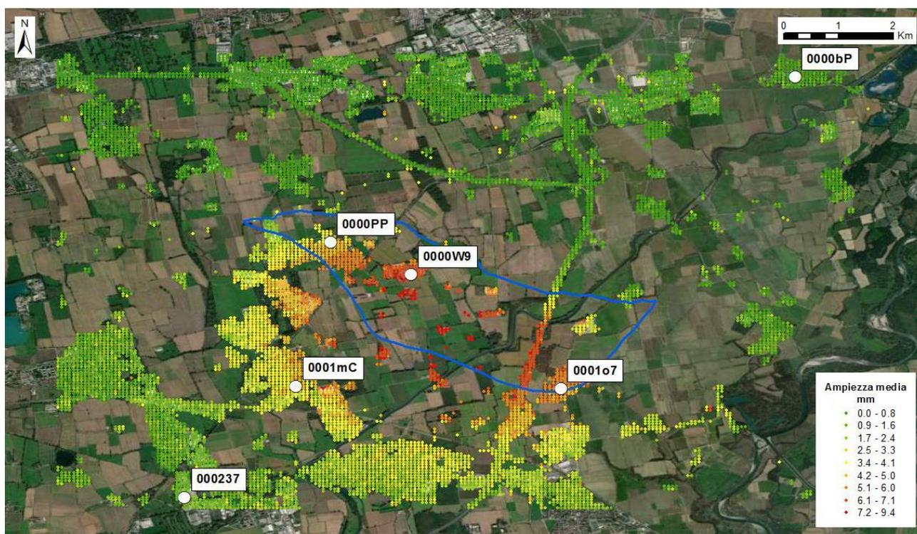
Fig. 36 Valori medi di ampiezza della stagionalità calcolati per la componente verticale dei PS Local e ubicazione dei 6 punti scelti rispetto alla proiezione in superficie del limite del giacimento.
