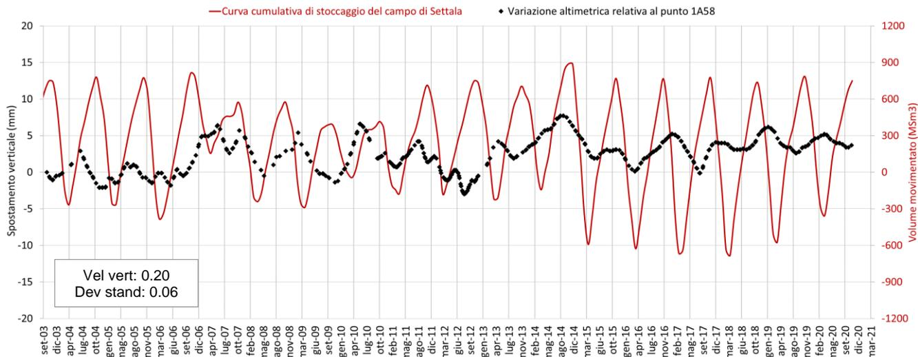
Fig. 28 Confronto tra l'andamento temporale delle variazioni altimetriche del punto scomposto 1A58 e la curva cumulativa di stoccaggio del giacimento di Settala.
