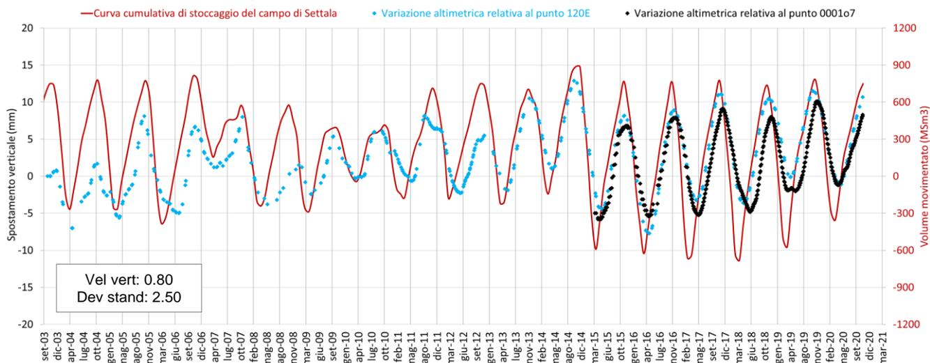
Fig. 40 Confronto tra l'andamento temporale delle variazioni altimetriche dei punti scomposti 120E (Radarsat) e 0001o7 (Sentinel), e la curva cumulativa di stoccaggio del giacimento di Settala.
