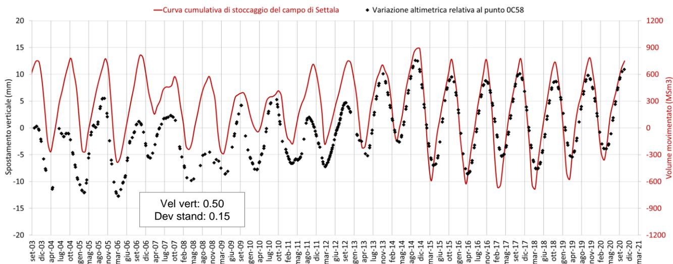
Fig. 25 Confronto tra l'andamento temporale delle variazioni altimetriche del punto scomposto 0C58 e la curva cumulativa di stoccaggio del giacimento di Settala.
