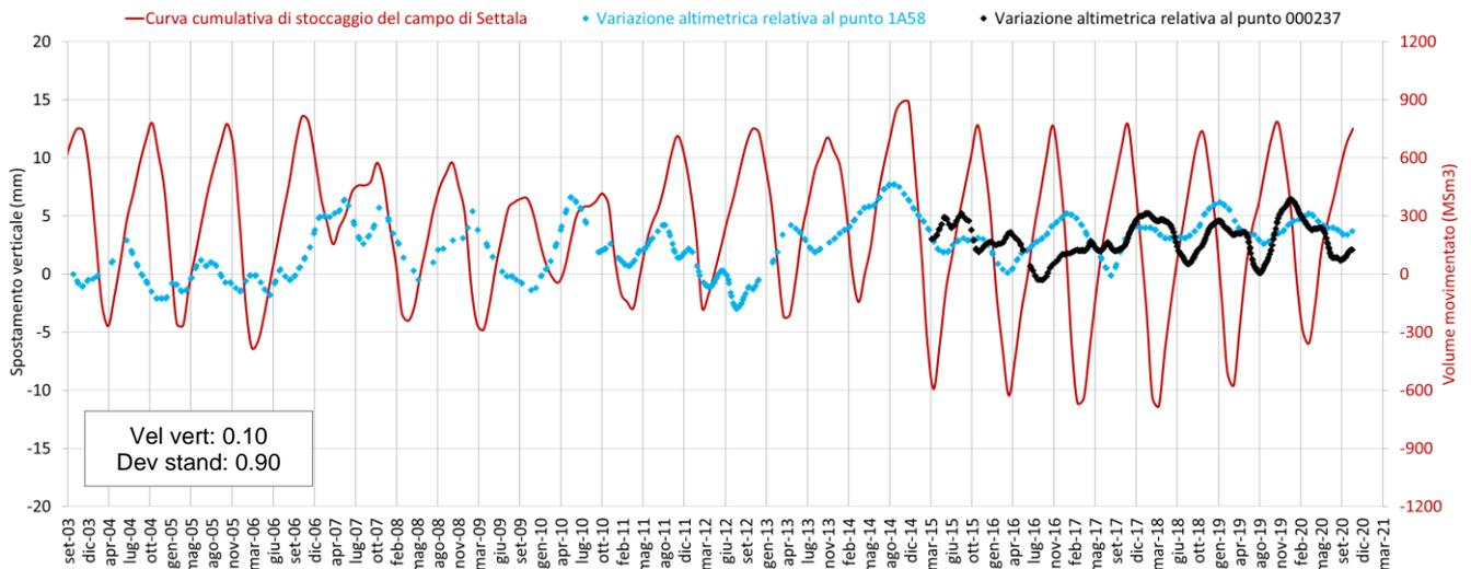
Fig. 42 Confronto tra l'andamento temporale delle variazioni altimetriche dei punti scomposti 1A58 (Radarsat) e 000237 (Sentinel), e la curva cumulativa di stoccaggio del giacimento di Settala.
