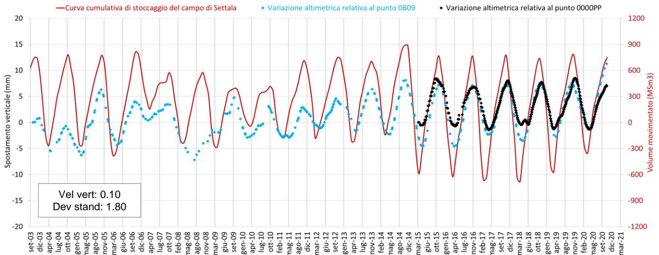
Fig. 38 Confronto tra l'andamento temporale delle variazioni altimetriche dei punti scomposti 0B09 (Radarsat) e 0000PP (Sentinel), e la curva cumulativa di stoccaggio del giacimento di Settala.
