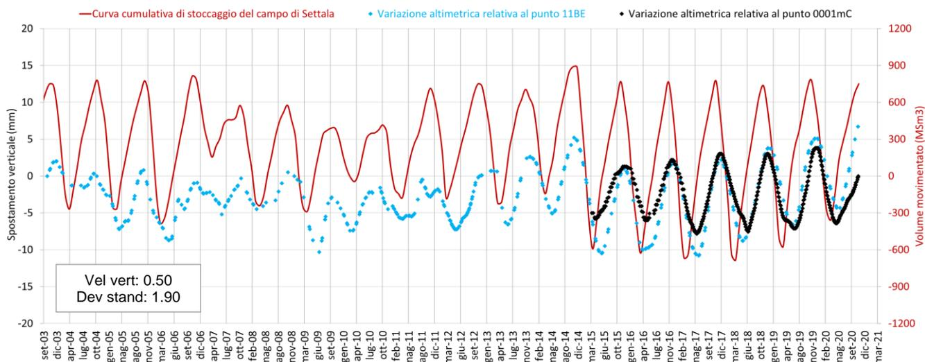
Fig. 41 Confronto tra l'andamento temporale delle variazioni altimetriche dei punti scomposti 11BE (Radarsat) e 0001mC (Sentinel), e la curva cumulativa di stoccaggio del giacimento di Settala.
