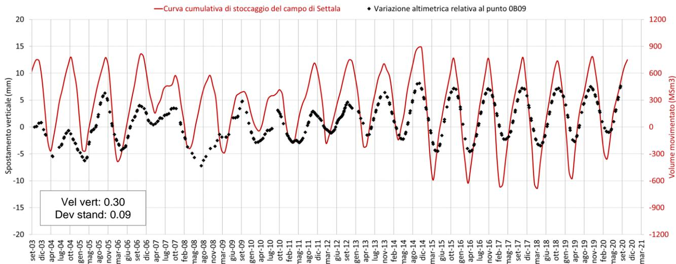
Fig. 24 Confronto tra l'andamento temporale delle variazioni altimetriche del punto scomposto 0B09 e la curva cumulativa di stoccaggio del giacimento di Settala.
