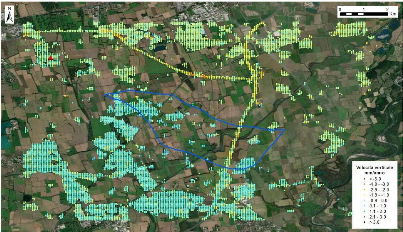
Fig. 34 *Dati Local scomposti secondo il vettore verticale. In evidenza il punto di riferimento utilizzato per la scomposizione del vettore velocità (triangolo rosso).*
