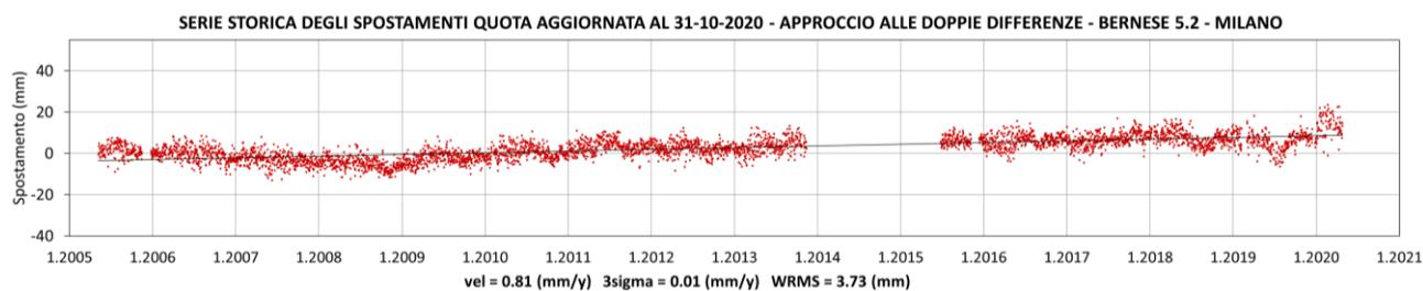
Fig. 10 Stima di velocità della componente verticale per il GPS di Milano.
