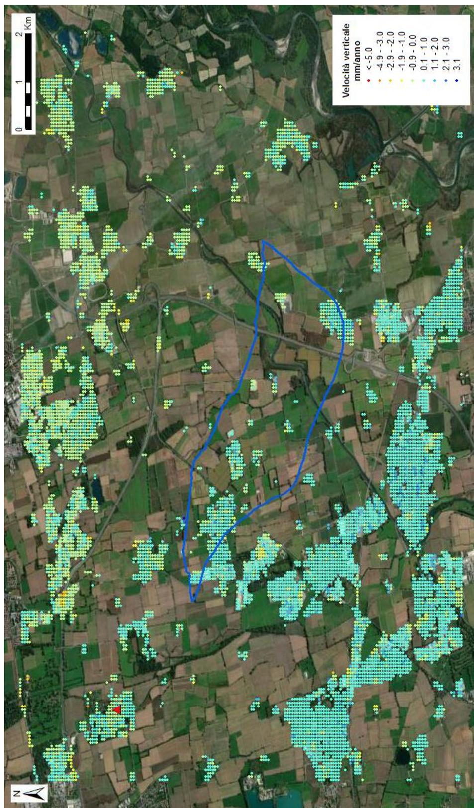
Fig. 17 Visualizzazione in scala di colori delle velocità verticali dei punti scomposti dell'analisi Local così come registrati dal satellite prima della calibrazione. Il triangolo rosso rappresenta il punto di riferimento.
