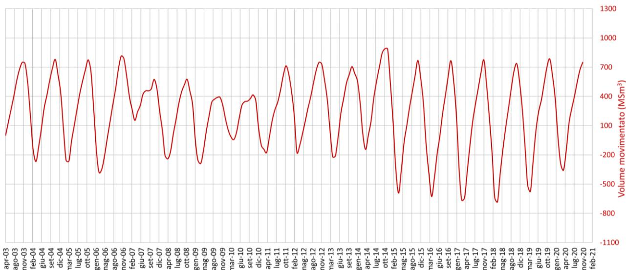
Fig. 6 Curva cumulativa di stoccaggio del campo di Settala (volumi in Milioni di Standard m<sup>3</sup> o MSm<sup>3</sup>).
