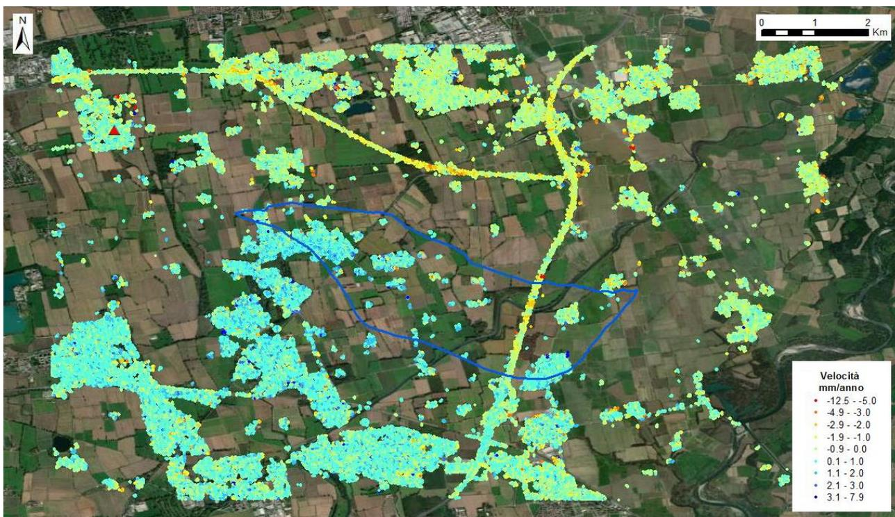
Fig. 32 Visualizzazione in scala di colori delle velocità del rilievo Local per i PS riconosciuti in modalità ascendente. In evidenza il punto di riferimento (triangolo rosso).
