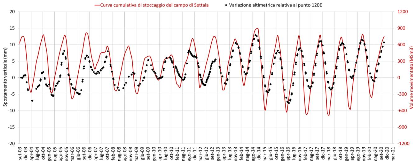
Fig. 26 Confronto tra l'andamento temporale delle variazioni altimetriche del punto scomposto 120E e la curva cumulativa di stoccaggio del giacimento di Settala.
