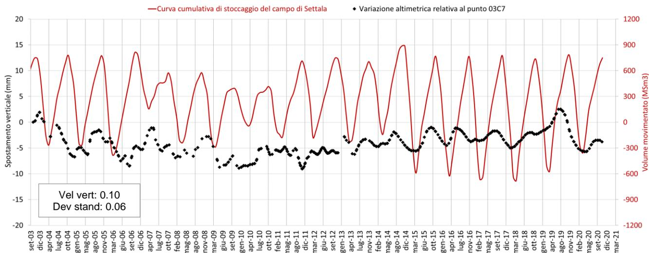
Fig. 29 Confronto tra l'andamento temporale delle variazioni altimetriche del punto scomposto 03C7 e la curva cumulativa di stoccaggio del giacimento di Settala.
