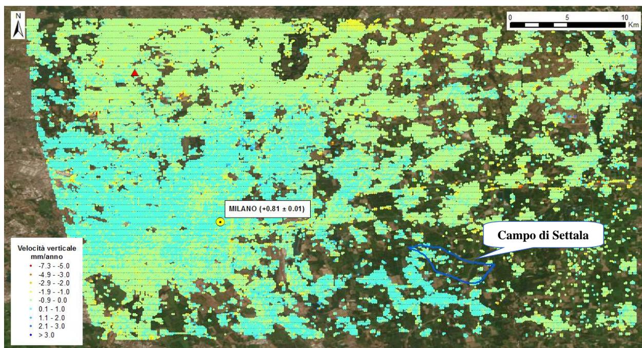
Fig. 11 Dati Regional scomposti secondo il vettore verticale. In evidenza il punto di riferimento utilizzato per la scomposizione del vettore velocità (triangolo rosso) e il CGPS di Milano utilizzato per la calibrazione (giallo).
