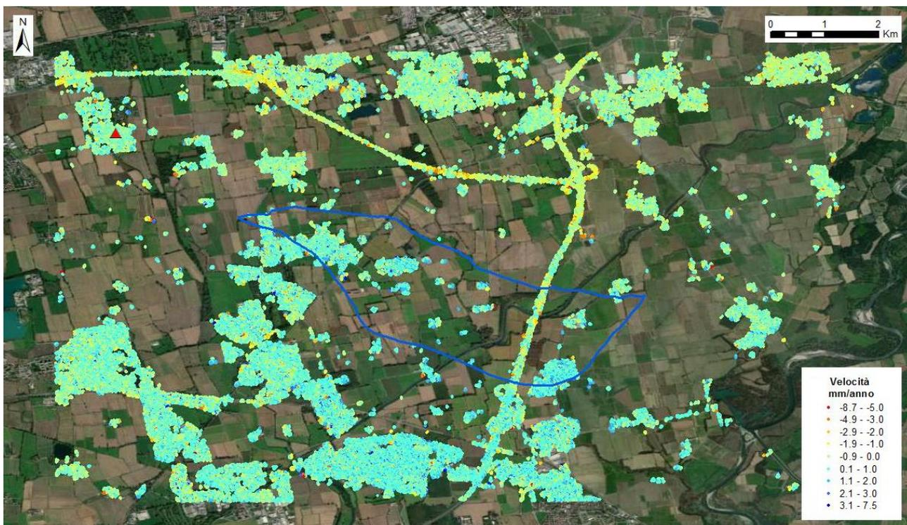
Fig. 33 Visualizzazione in scala di colori delle velocità del rilievo Local per i PS riconosciuti in modalità discendente. In evidenza il punto di riferimento (triangolo rosso).
