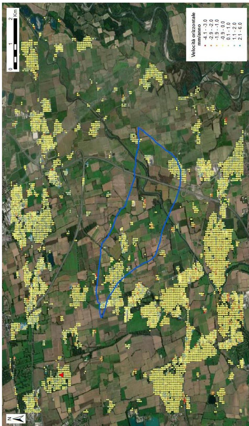
Fig. 21 *Dati Local scomposti secondo il vettore orizzontale. In evidenza il punto di riferimento utilizzato per la scomposizione del vettore velocità (triangolo rosso).*
