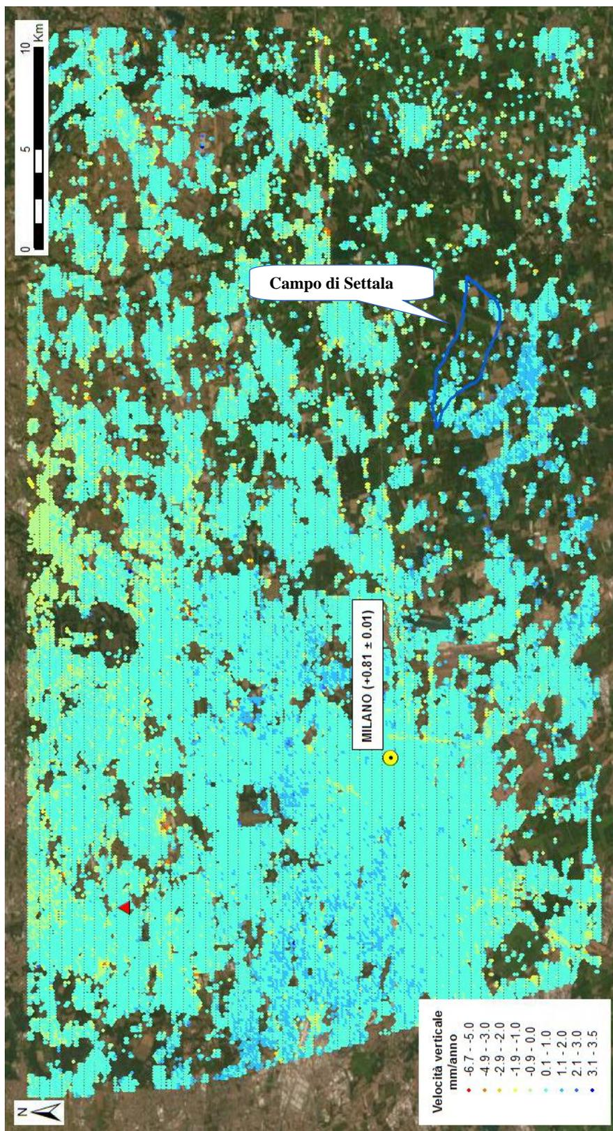
Fig. 14 Dati Regional scomposti secondo il vettore verticale e calibrati. In evidenza l'ubicazione del CGPS usato per la calibrazione, il punto di riferimento (triangolo rosso) e il limite del giacimento di Settala.
