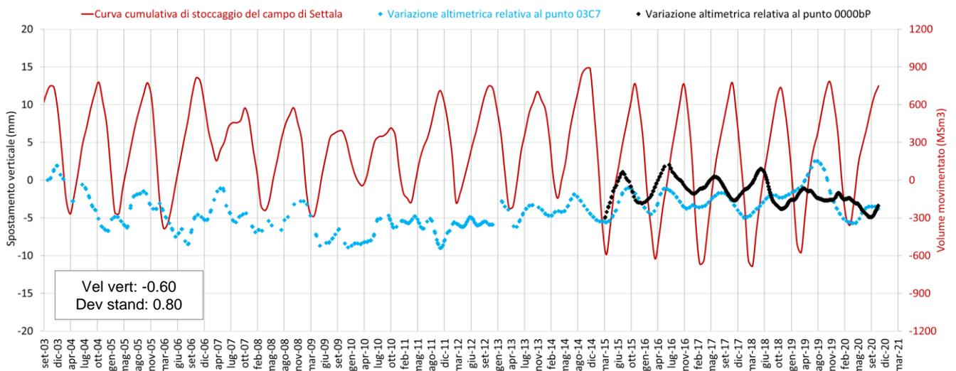
Fig. 43 Confronto tra l'andamento temporale delle variazioni altimetriche dei punti scomposti 03C7 (Radarsat) e 0000bP (Sentinel), e la curva cumulativa di stoccaggio del giacimento di Settala.
