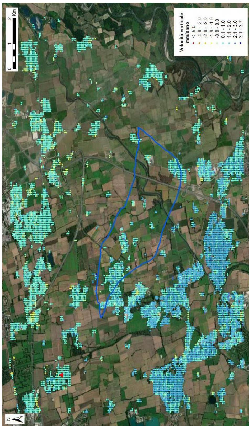
Fig. 20 Dati Local scomposti secondo il vettore verticale dopo la calibrazione. In evidenza il punto di riferimento utilizzato per la scomposizione del vettore velocità (triangolo rosso).
