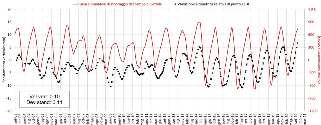
Fig. 27 Confronto tra l'andamento temporale delle variazioni altimetriche del punto scomposto 11BE e la curva cumulativa di stoccaggio del giacimento di Settala.
