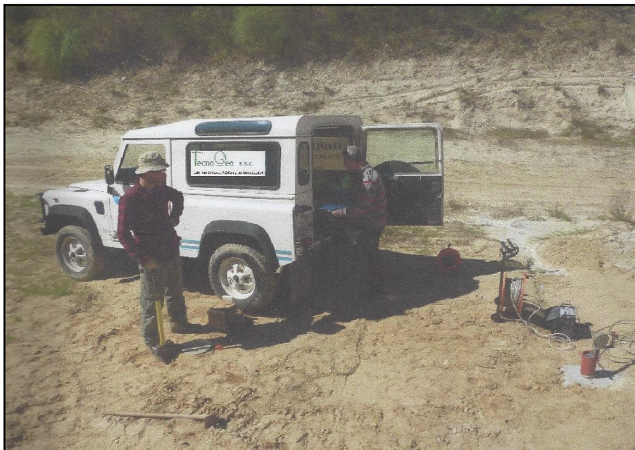
Figura 1. Indagine sismica Down Hole
