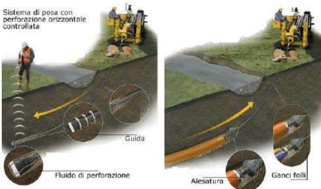
Posa in opera tubazione con trivellazione teleguidata
