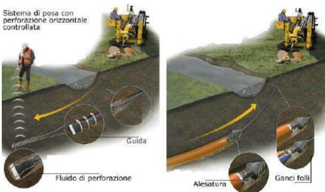
Posa in opera tubazione con trivellazione teleguidata
