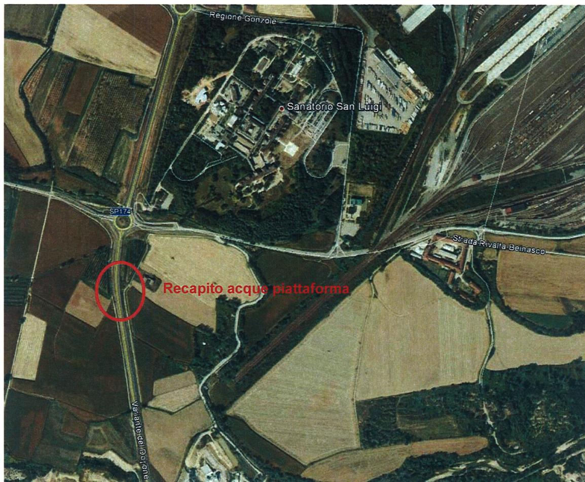
Figura 2: Recapito acque di piattaforma in corrispondenza del fosso parallelo alla sede stradale della variante del Dojirone
