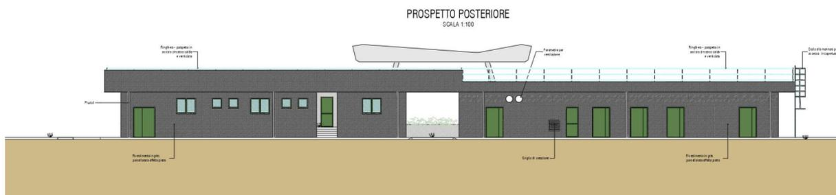
In copertura un parapetto metallico lega ed unisce i due edifici distinti. Lo smaltimento dell'acqua piovana avviene sul retro dando una pendenza dell'1,2%. L'acqua, attraverso i pluviali, viene portata in un serbatoio di accumulo sul lato dell'edificio verso l'Autostrada, previo filtraggio, per il riutilizzo come scarico WC e l'irrigazione esterna.
