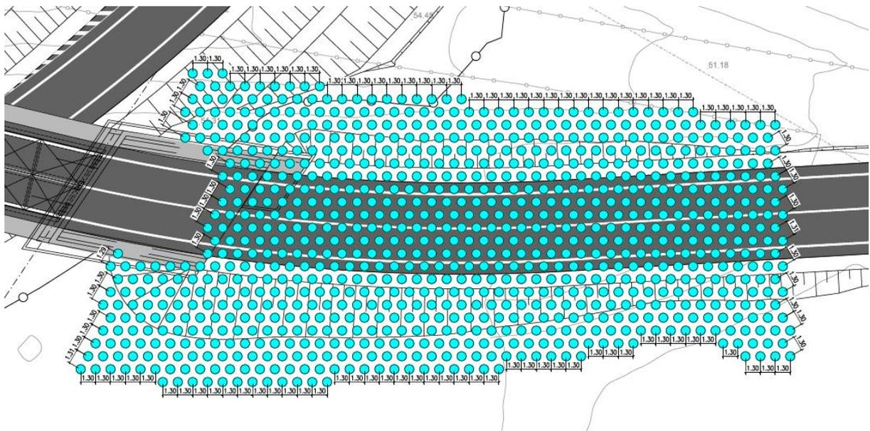
L'intervento in colonne di ghiaia è stato dimensionato al fine di ridurre i cedimenti previsti sul rilevato e renderli compatibili con la fruibilità dell'opera. La lunghezza delle colonne è funzione della potenza dello strato deformabile su cui poggierà il rilevato stradale.
