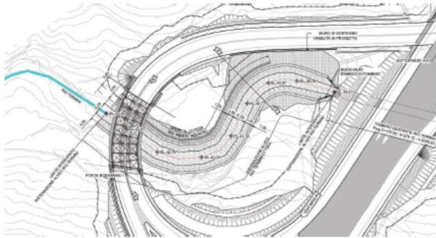
Fig. 0 1 Sistemazione Rio Termini in corrispondenza del “cappio” di svincolo
