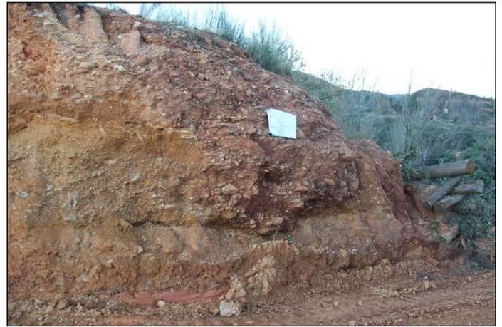
I depositi di origine deltizia del Basso-Medio Pleistocene (PT1), visti gli spaccati stratigrafici affioranti sul terreno e viste le stratigrafie profonde dei sondaggi, possono essere descritti come prevalenti livelli ed orizzonti di limi, limi sabbiosi, limi argillosi che si alternano a livelli secondari di ghiaie in matrice sabbiosa, sabbioso-limosa.
