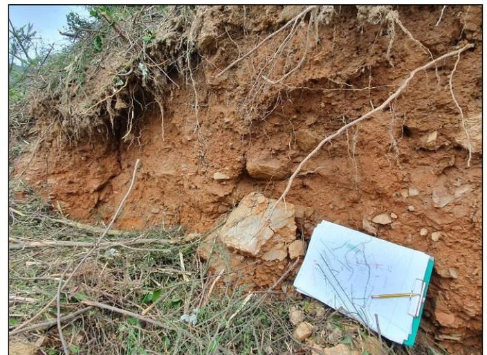
**Il taglio del ribasso evidenzia la presenza di una copertura detritica arrossata il cui spessore è stato stimato, anche sulla base della tomografia sismica eseguita lungo la massima pendenza della frana, compreso tra 3-5m.**
