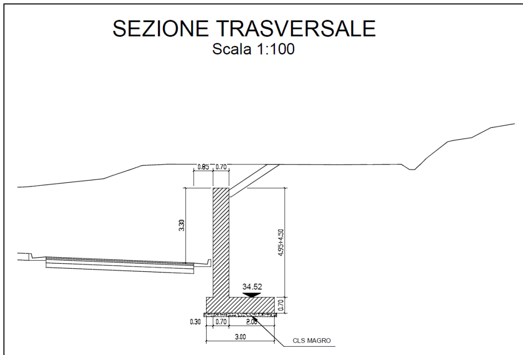
Figura 7.3 – Sezione tipologica muro gettato in opera
