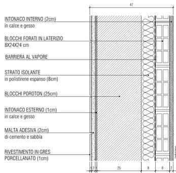
E2 MURATURA PERIMETRALE EDIFICIO IMPIANTI sp. 31 cm (rivestimento esterno in gres)
