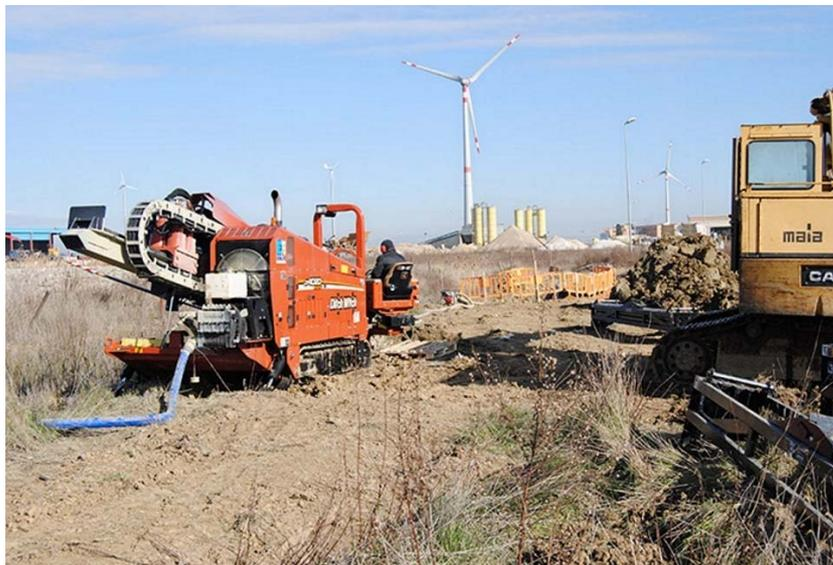
Fig. 3.2.18 - Apparecchiatura per trivellazione orizzontale controllata o teleguidata (T.O.C.)
