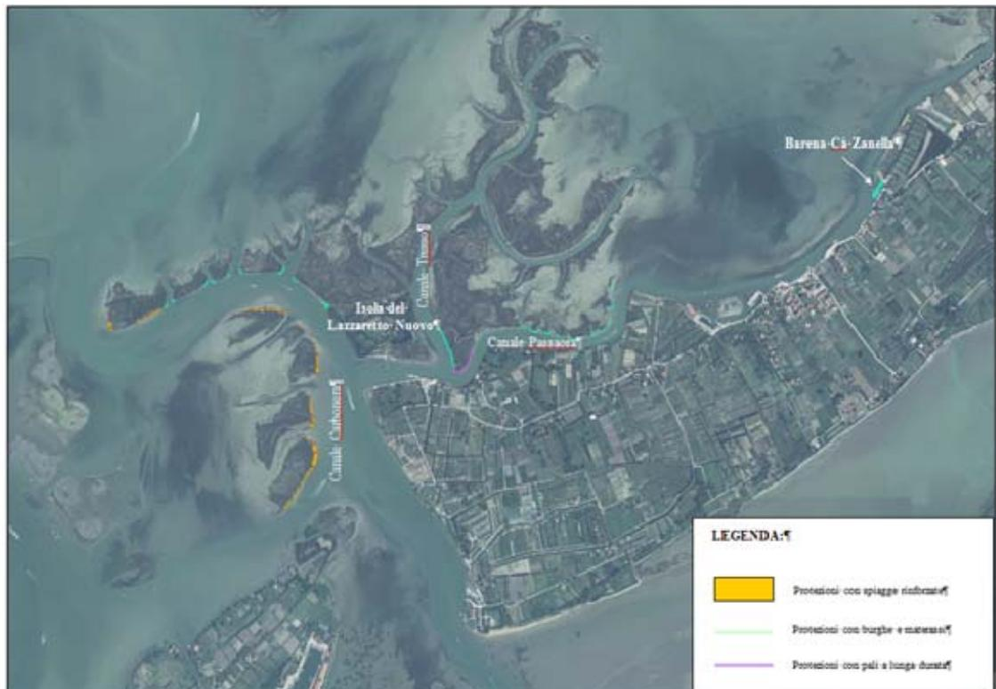
**Figura 5-9** Interventi di protezione dei margini barenali realizzati nell'ambito del primo stralcio lungo il canale Passaora, Carbonera, Tresso.
