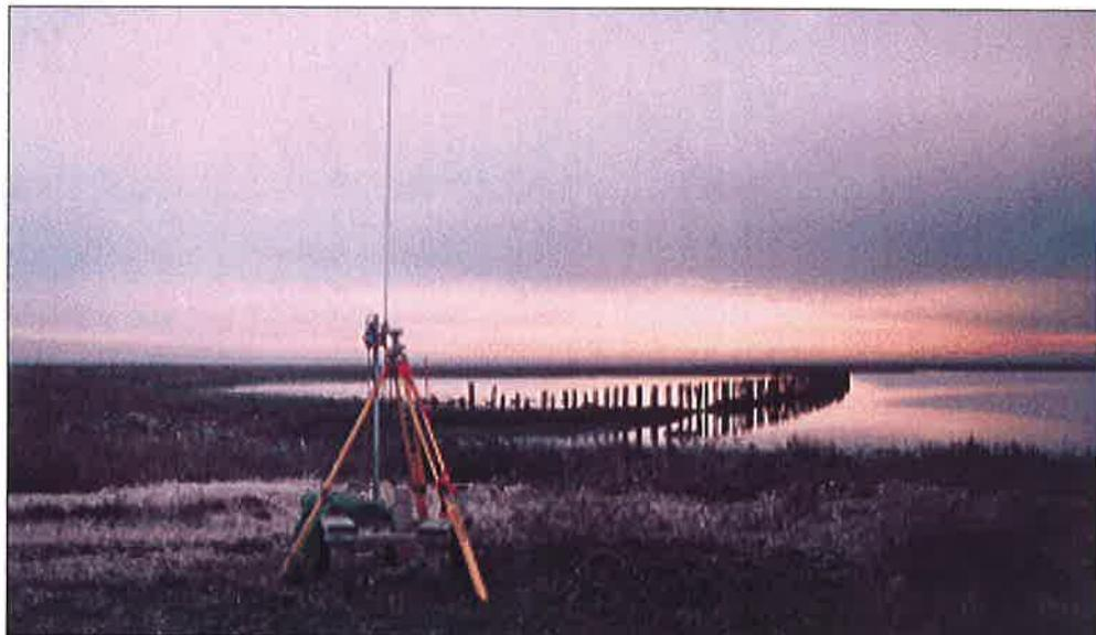
**Figure 3.1 -Esempio di stazione base con caposaldo.**
