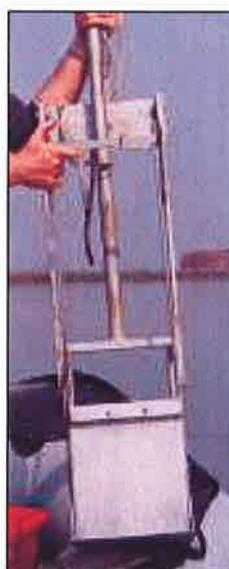
**Figura 4.1: A sinistra: box corer idraulico. A destra: box corer manuale**
