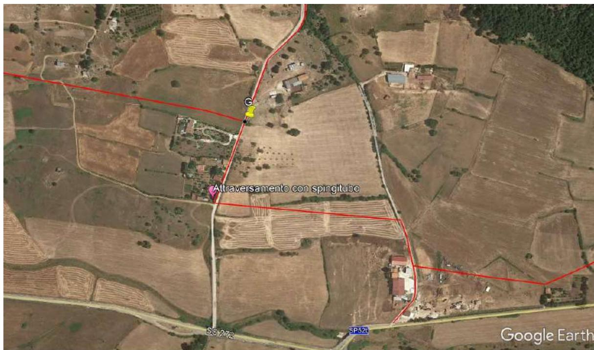
*Foto 2b: Attraversamento di strada comunale con la condotta idrica, mediante la tecnica dello spingitubo*
