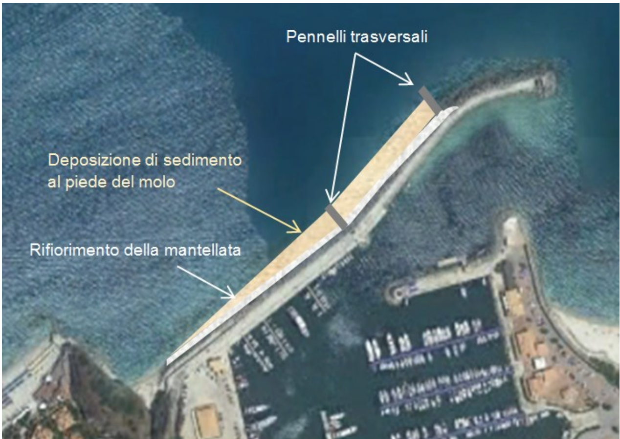
Figura 15 – Planimetria tipologica di intervento: ubicazione dei pennelli trasversali semisommersi ed effetti attesi di stabilizzazione del piede del molo.
