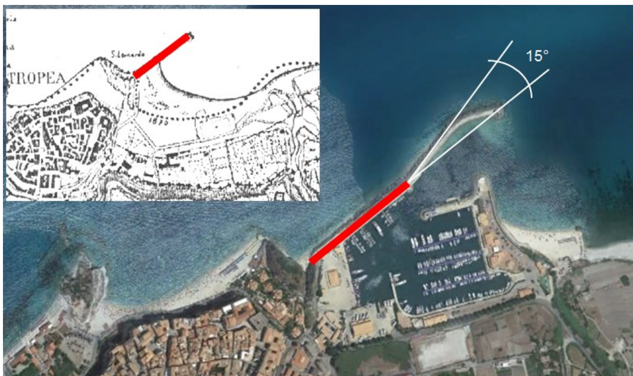
Figura 12 – Evidenziazione del punto angoloso lungo il paramento esterno del molo di sopraflutto, posto all'attacco tra il molto originario del 1947 ed il successivo prolungamento.
