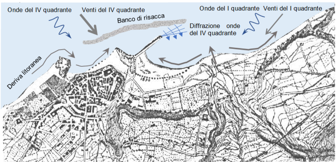
Figura 6 – Situazione nel 1947. La costruzione del molo non ha fatto che spostare il punto di diffrazione delle onde sulla testata dell'opera. Lo specchio acqueo in cui sorgerà il porto è ancora interessato da una deriva litoranea da Est a Ovest che accumula nella baia i sedimenti trasportati dal Lumia e dal delta del Torrente Grazie (che ha frattanto ricevuto come affluente il Torrente Burmaria).
