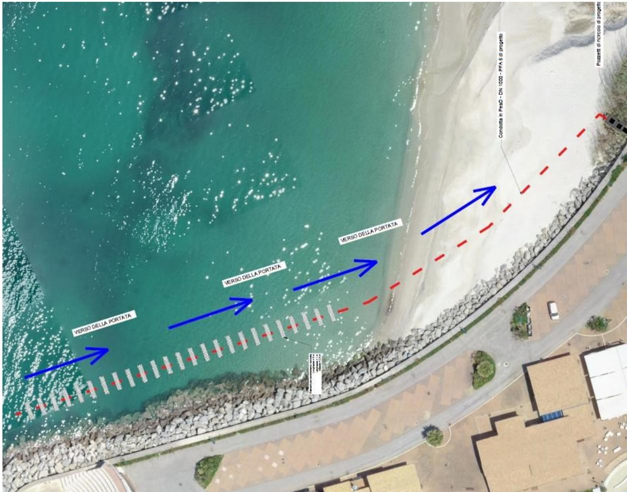
Figura 3: Planimetria della condotta di ricircolo di progetto
