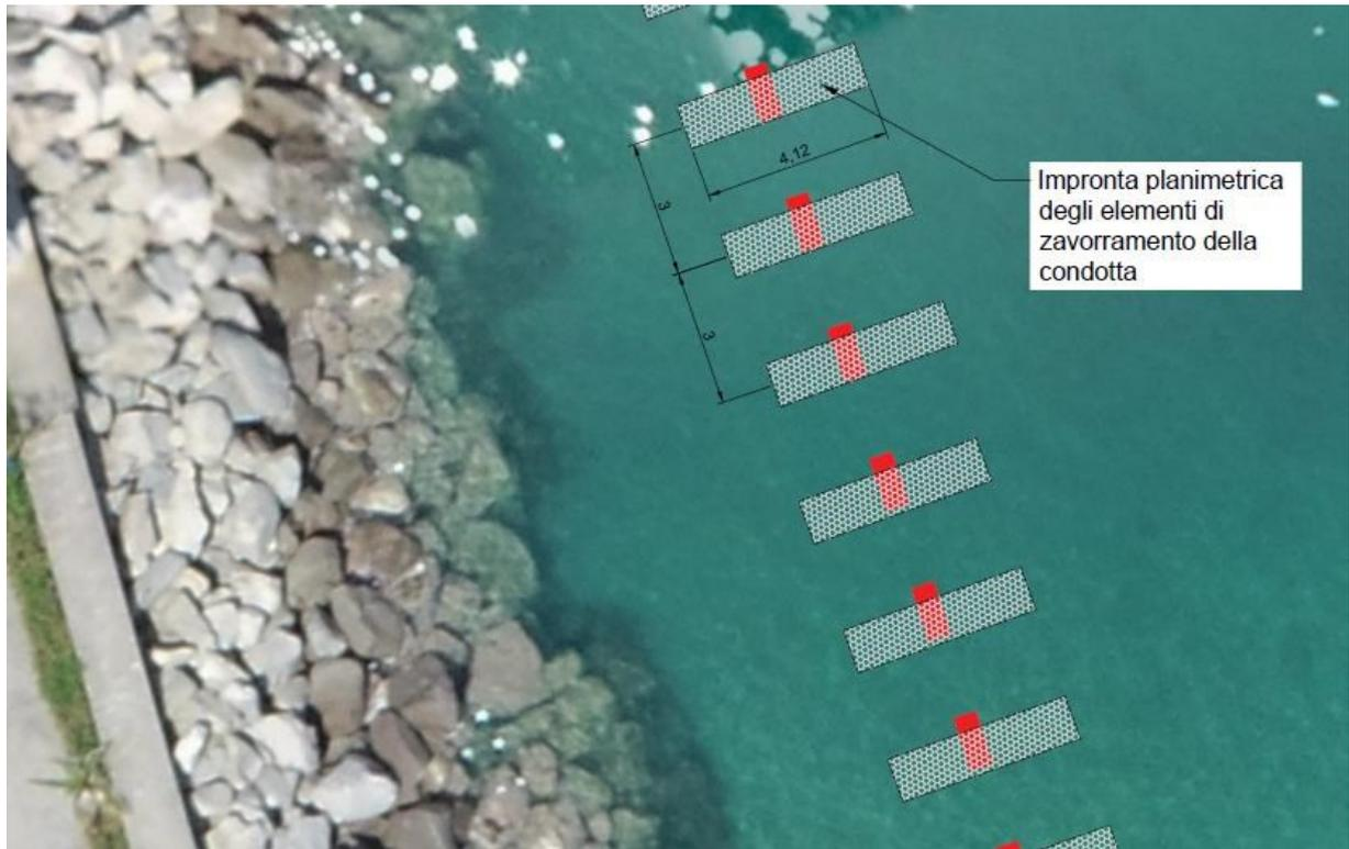
Figura 5: Particolare della posa delle gabbionate di zavorramento.
