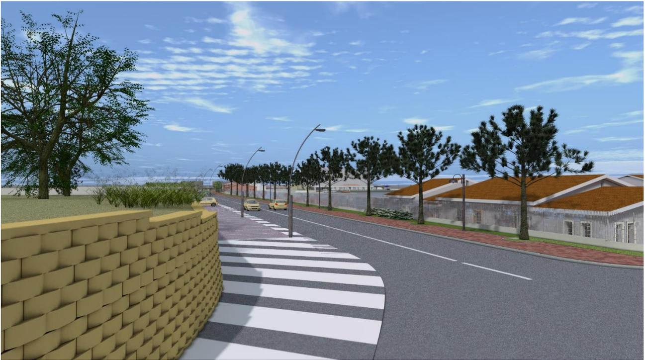
*Figura 16 – Render di via marina Vescovado – viale Raf Vallone nella nuova configurazione, in primo piano il muro a secco in blocchi di cemento*
