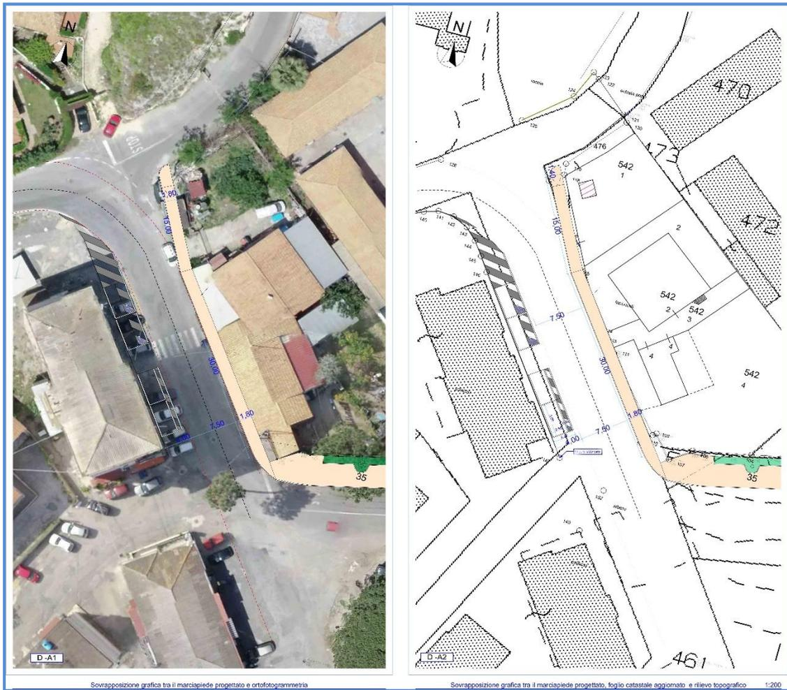
Figura 5 – sovrapposizione grafica tra il marciapiede progettato, rilievo orto fotogrammetrico e catastale aggiornato
