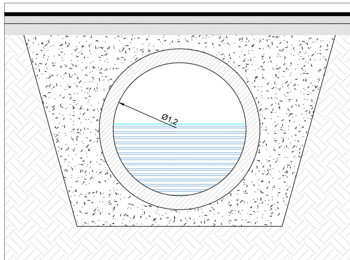
Sezione tipo di condotta in calcestruzzo armato vibrocompreso
