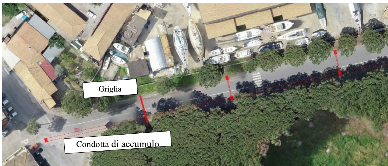
Figura 5: Griglie di immissione lato Sud-Ovest.
