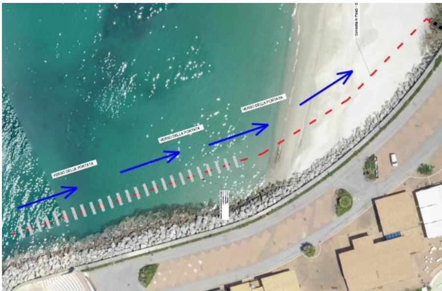
Figura 36: Planimetria della condotta di ricircolo di progetto
