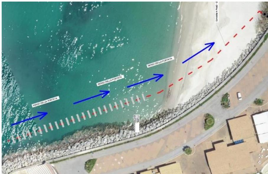
Figura 25: Planimetria della condotta di ricircolo di progetto
