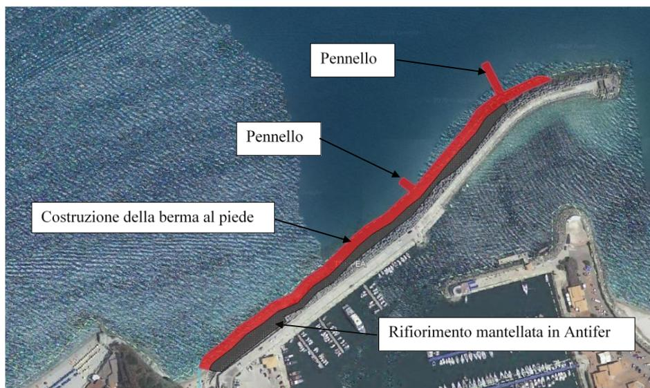
Figura 20: Schema planimetrico delle opere di progetto per ripristino della mantellata e la limitazione dell'insabbiamento dell'imboccatura.
