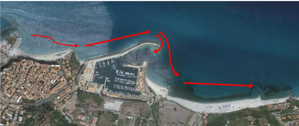
Figura 8: Schema dell'andamento prevalente delle correnti indotte dal moto ondoso
