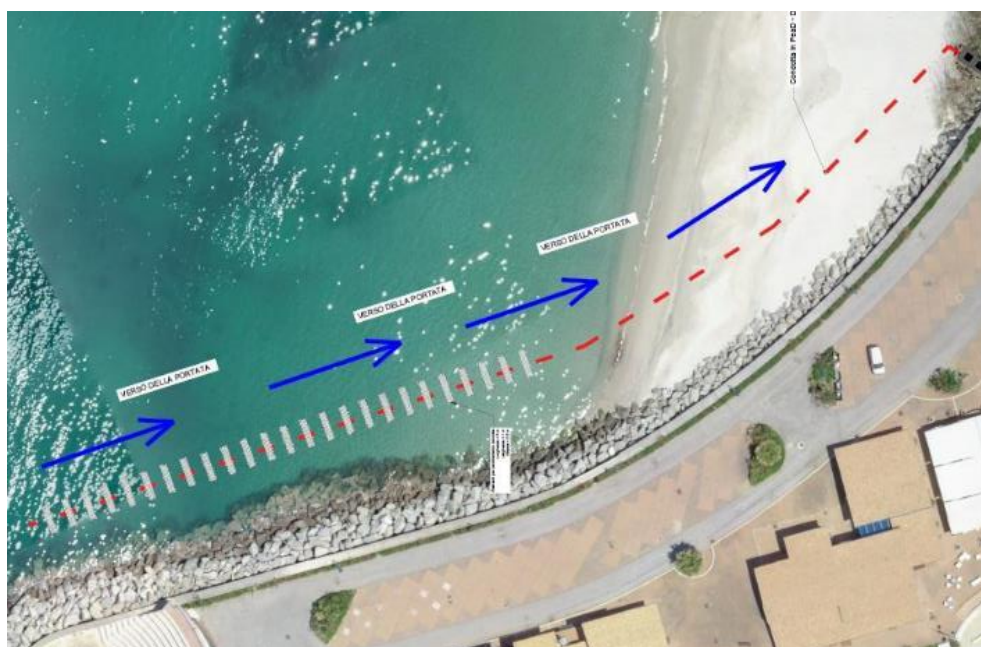
Figura 12: Planimetria della condotta di ricircolo di progetto
