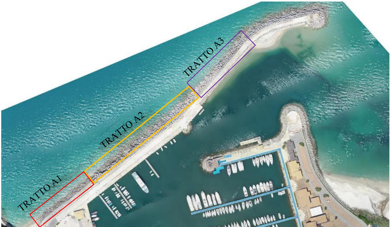
Figura 5: Suddivisione schematica del muro paronde
