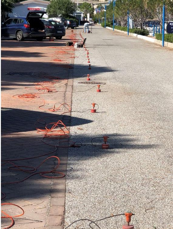
**Prospezione sismica di tipo masw – MASW1**
