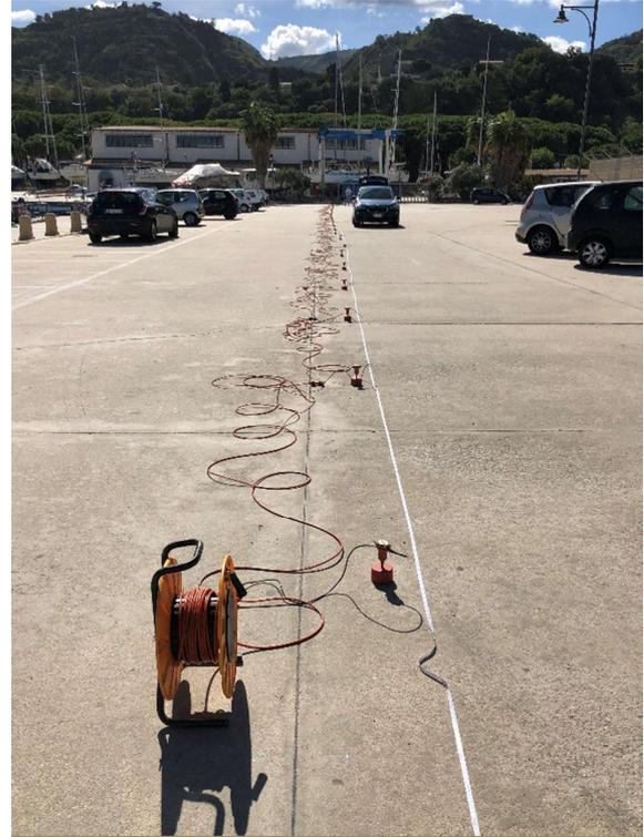
**Prospezione sismica di tipo masw – MASW2**
