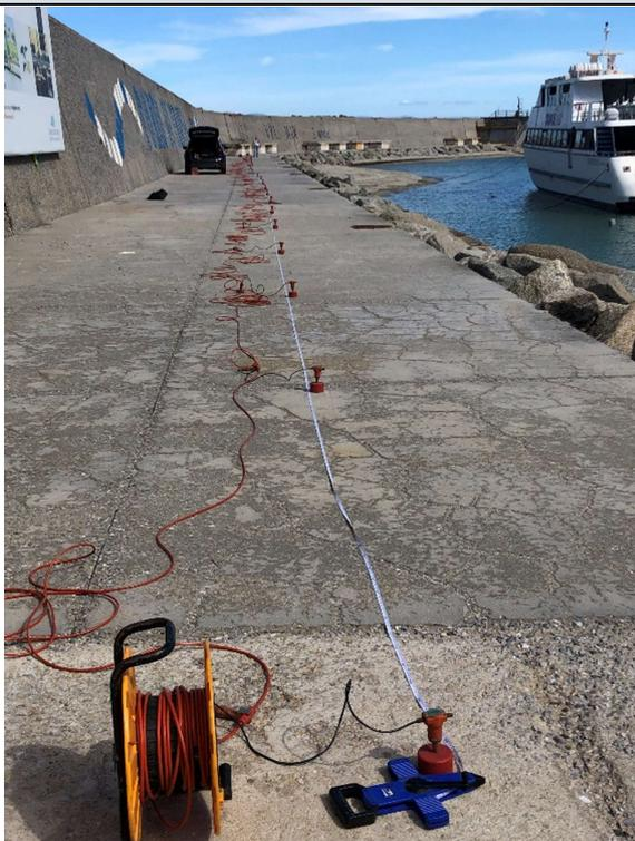
**Prospezione sismica di tipo masw – MASW3**
