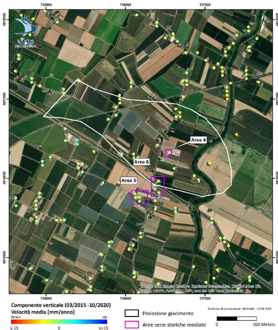
Figura 15: Dettaglio della componente verticale nell'area del Pool B. Le serie storiche dei punti all'interno delle aree viola sono stati mediati per ottenere le serie storiche medie mostrate in Figura 17
