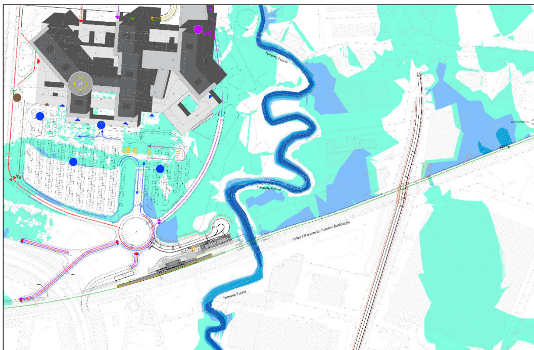
Figura 26: Modello 2D del T. Fuorni: aree potenzialmente inondabili ( Tr = 200 anni, configurazione post operam)
