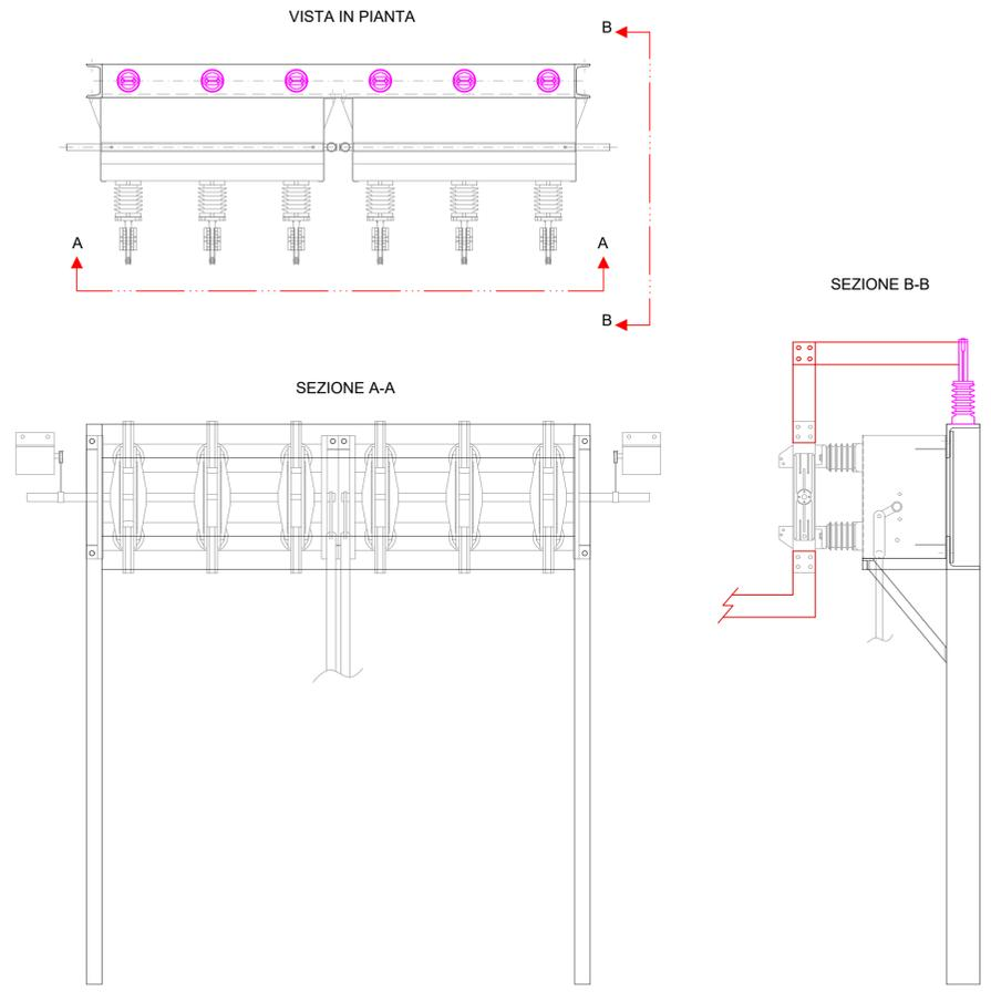
VISTE DI DETTAGLIO CARPENTERIA DI SUPPORTO ESAPOLARE (Scala 1:20)
