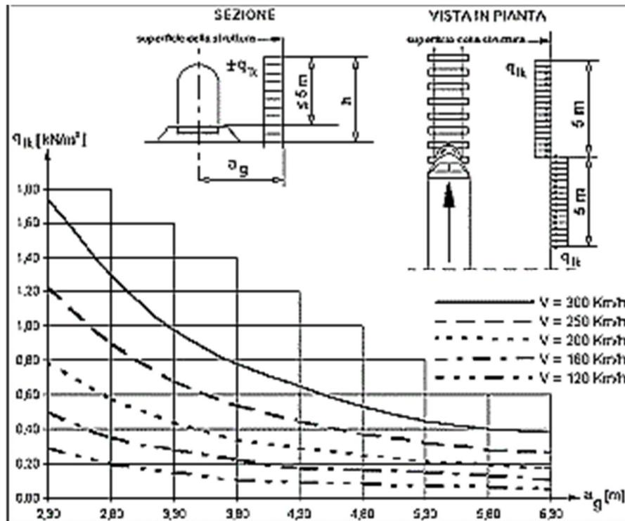
Assumendo una velocità del treno di 250 km/h e con  $a_g=3,30$  m, tenendo conto dei fattori correttivi  $k_1=1,0$  e  $k_2=1,3$ , si ottiene un valore di  $q_{1k}$  pari a **91,00 daN/mq**.
