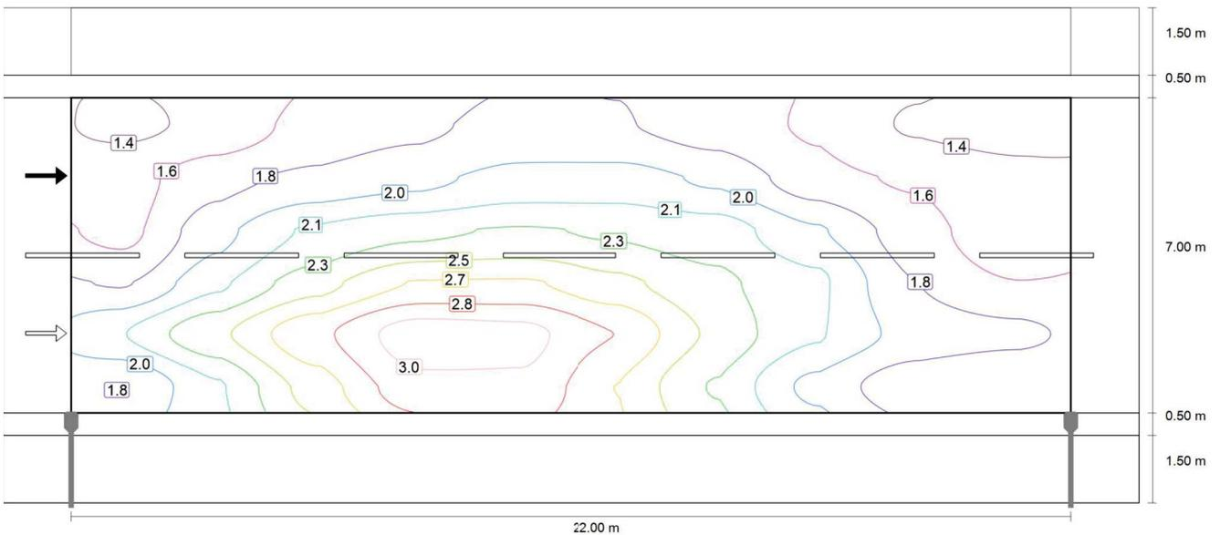
Osservatore 2: Luminanza per nuova installazione [cd/m<sup>2</sup>] (Curve isolux)
