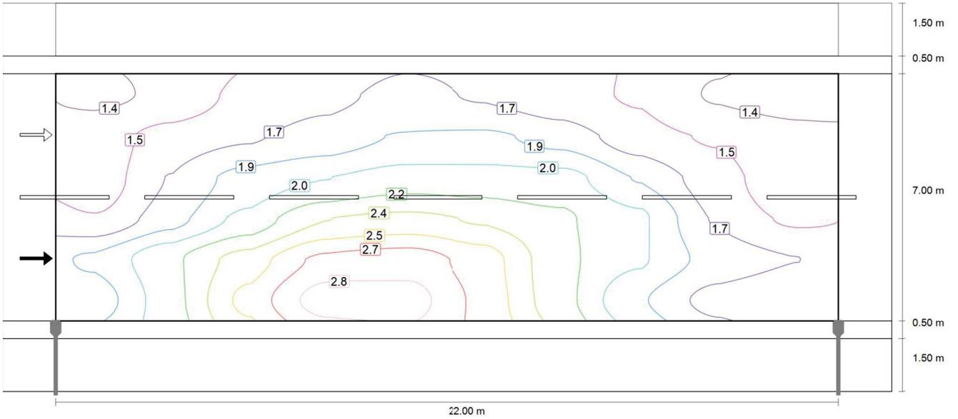
Osservatore 1: Luminanza per nuova installazione [cd/m<sup>2</sup>] (Curve isolux)
