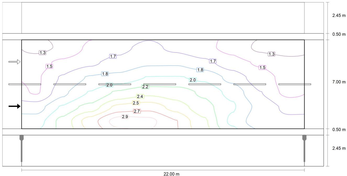
Osservatore 1: Luminanza per nuova installazione [cd/m<sup>2</sup>] (Curve isolux)
