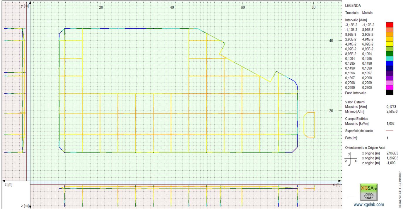
**Fig. 22 – Distribuzione delle correnti disperse nel terreno a seguito di guasto**
