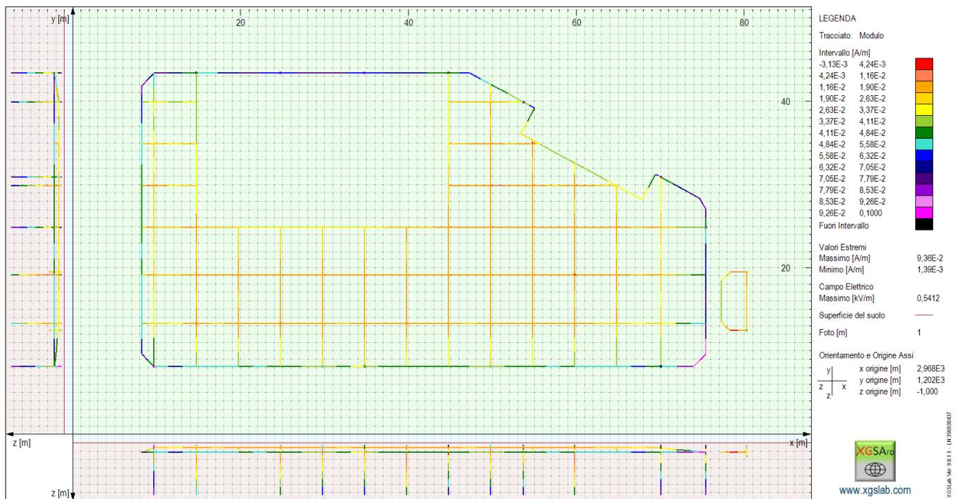
**Fig. 16 – Distribuzione delle correnti disperse nel terreno a seguito di guasto**
