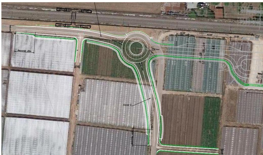
**Figura 6** – NV05B: Nuova rotatoria su strada locale e riprofilatura rami di innesto
