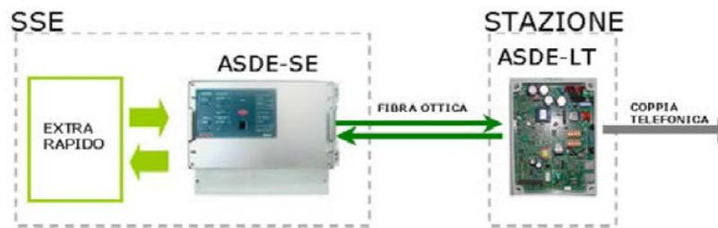
*Figura 6 – Separazione galvanica degli asservimenti*
