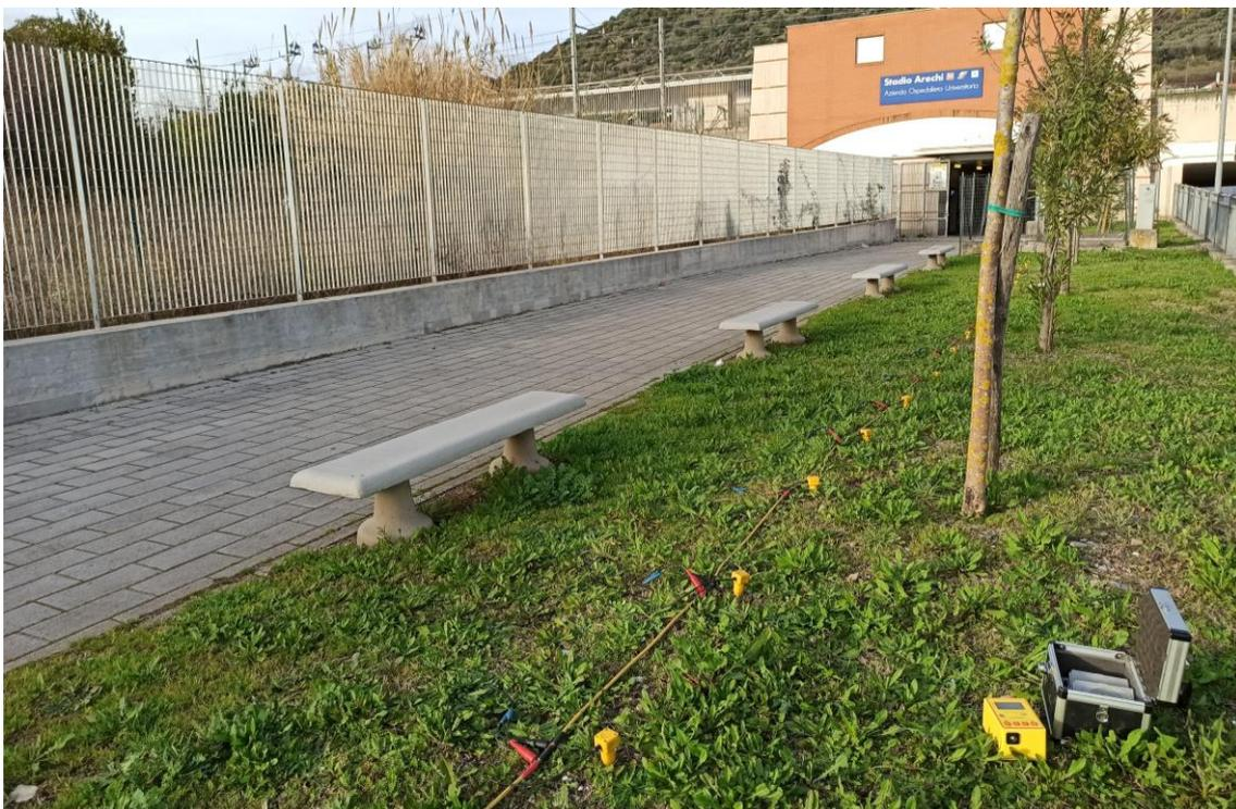
**Figura 29:** Foto relativa all'esecuzione della prova HVSr BH1.
