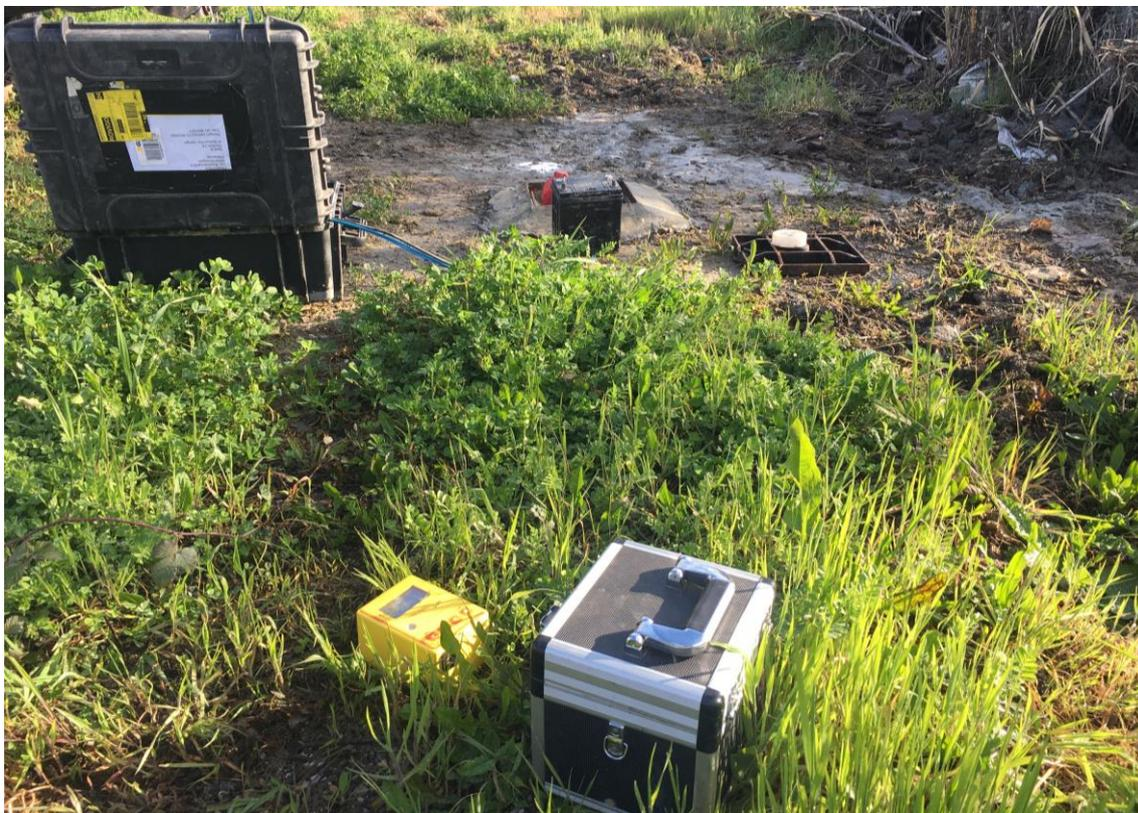
**Figura 37:** Foto relativa all'esecuzione della prova HVSR BH16.
