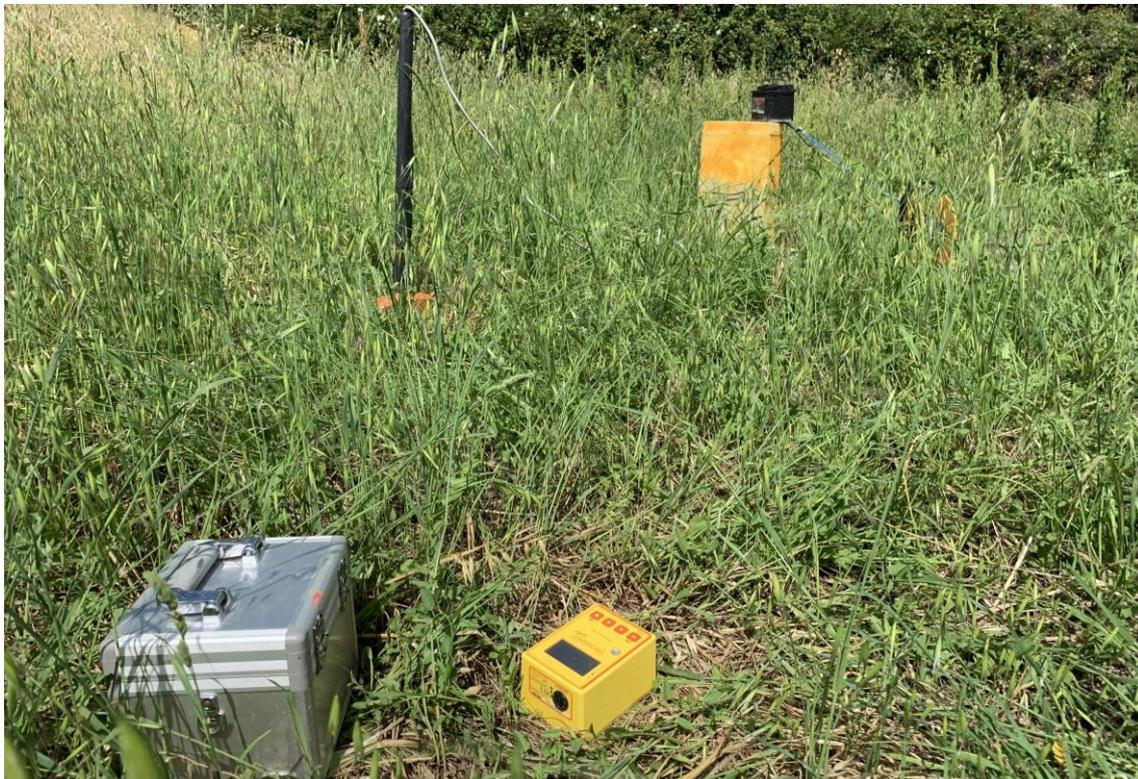
Figura 51: Foto relativa all'esecuzione della prova HVSr BH 08.
