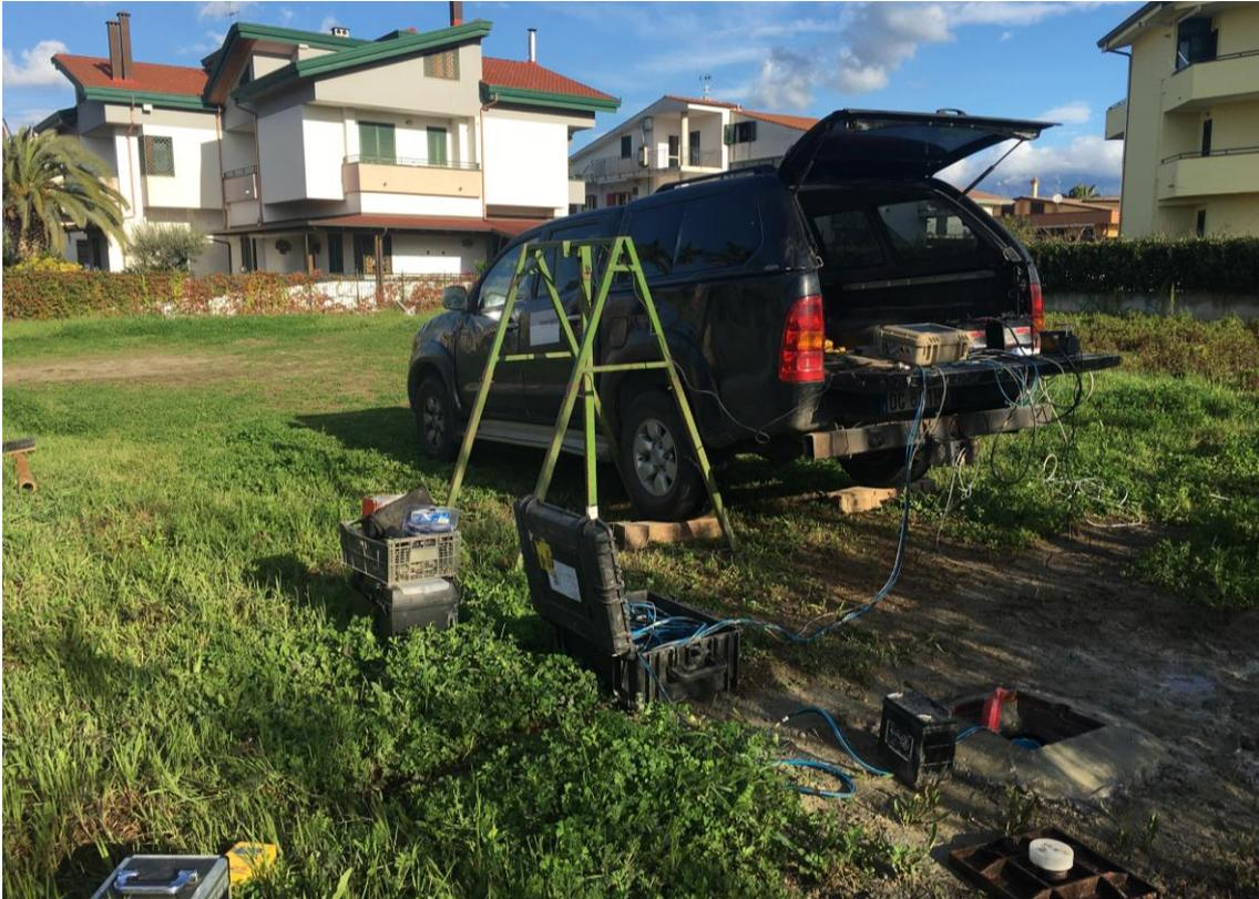
**Figura 63:** foto relativa all'esecuzione della prova down-hole BH16.
