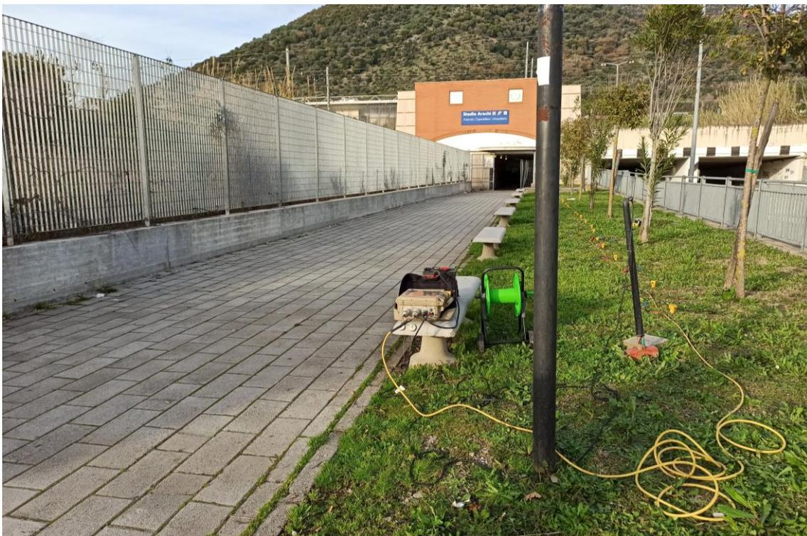
Figura 7: Foto relativa all'esecuzione della prova MASW BH1.
