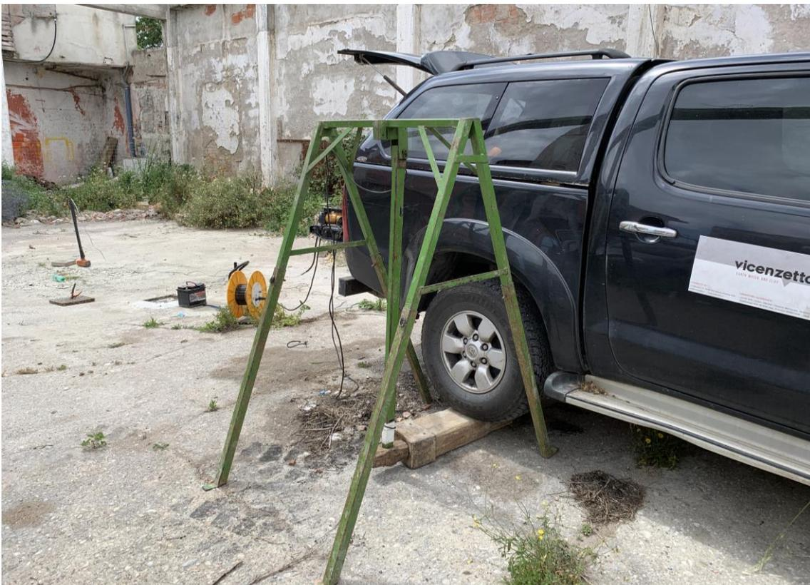
Figura 93: foto relativa all'esecuzione della prova down-hole BH 12.
