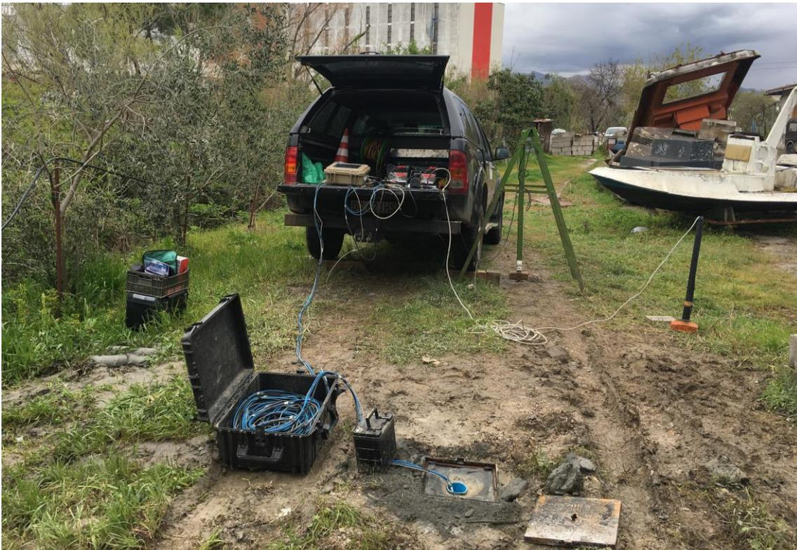
Figura 68: foto relativa all'esecuzione della prova down-hole BH19.
