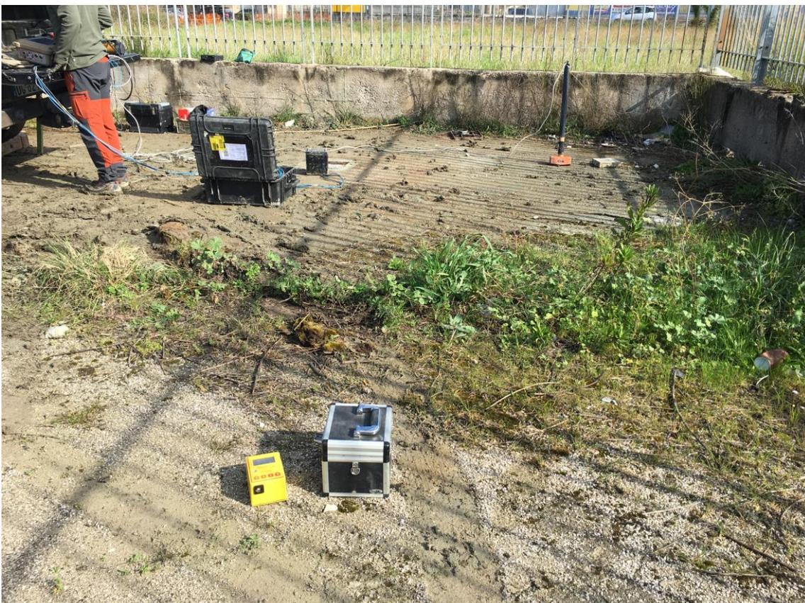
**Figura 43:** Foto relativa all'esecuzione della prova HVSR BH23.
