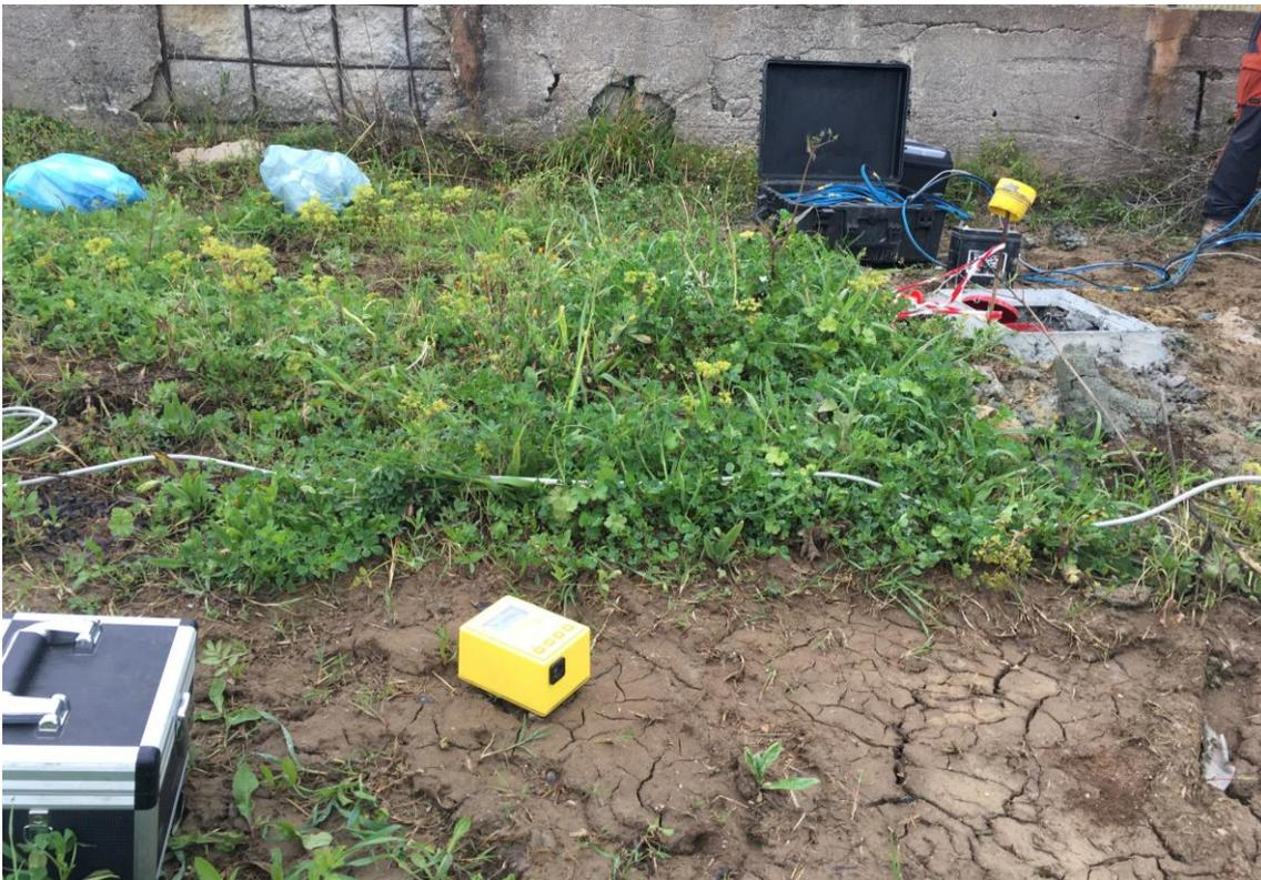
Figura 45: Foto relativa all'esecuzione della prova HVSr BH24.
