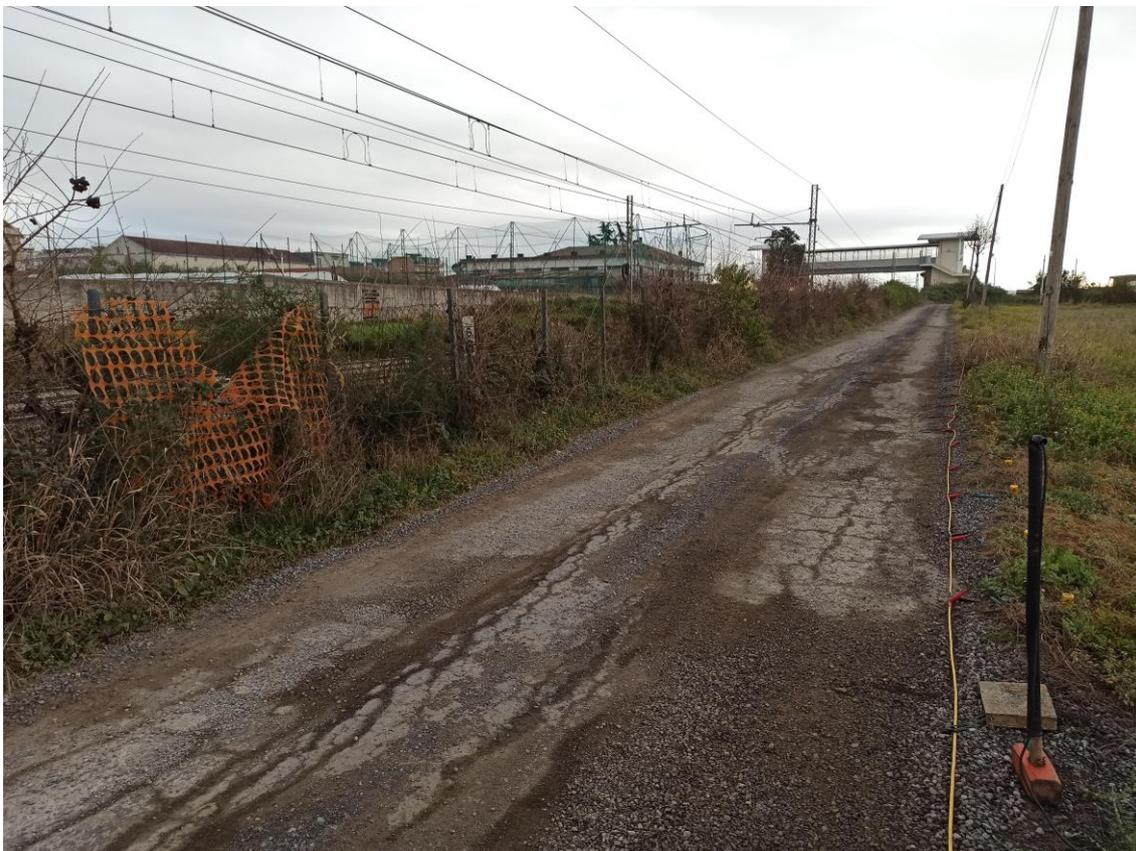
**Figura 22:** Foto relativa all'esecuzione della prova MASW BH20.
