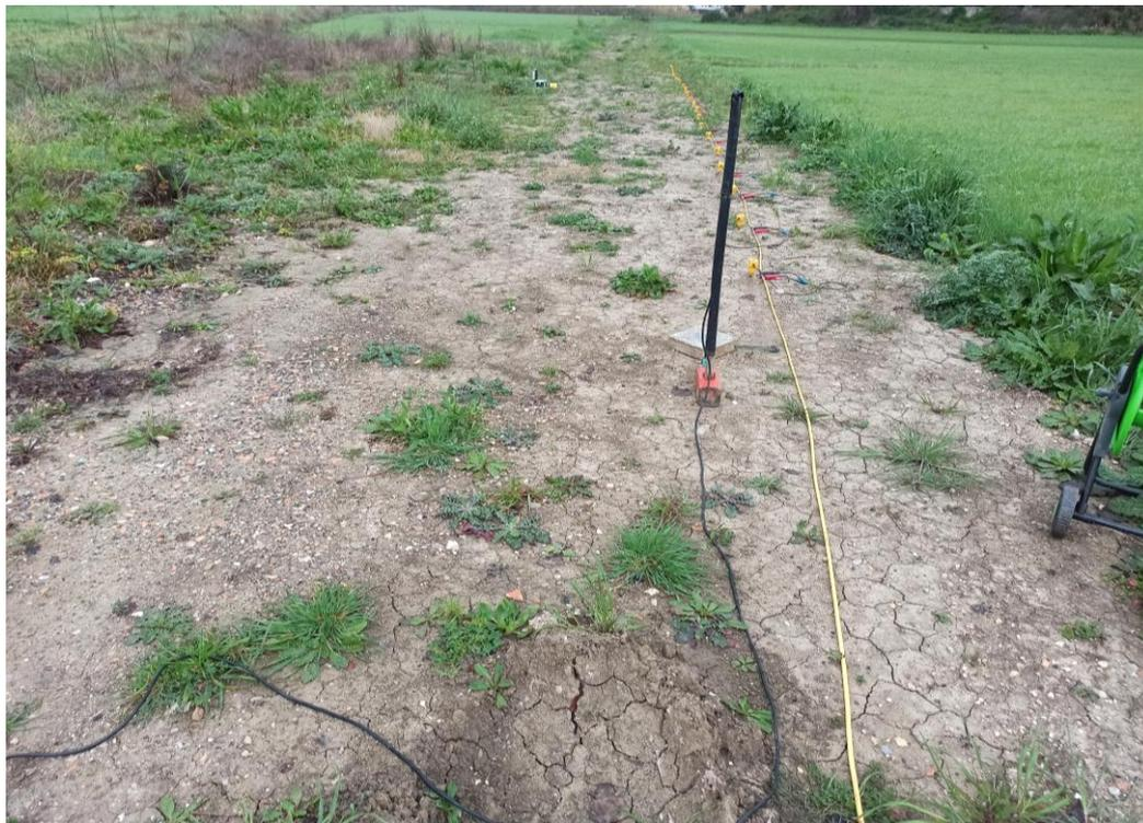
**Figura 17:** Foto relativa all'esecuzione della prova MASW BH15.
