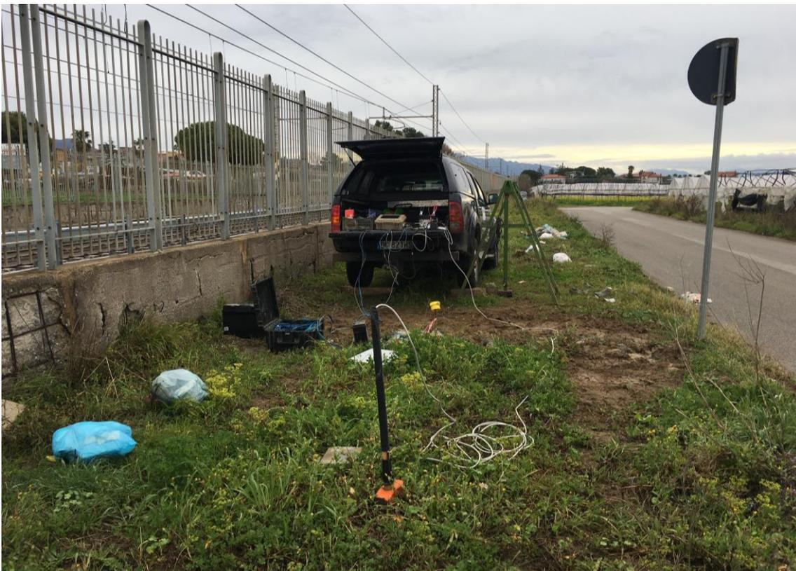
Figura 78: foto relativa all'esecuzione della prova down-hole BH24.
