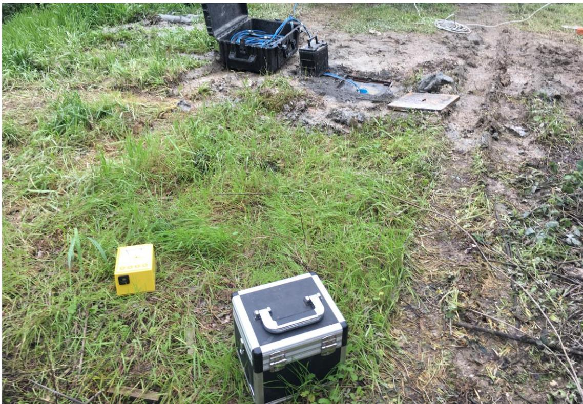
**Figura 39:** Foto relativa all'esecuzione della prova HVSr BH19.
