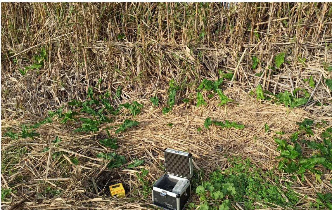
Figura 31: Foto relativa all'esecuzione della prova HVSR BH3.
