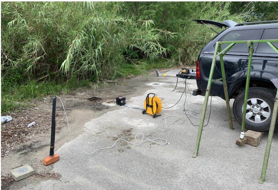
**Figura 83:** foto relativa all'esecuzione della prova down-hole BH 06
