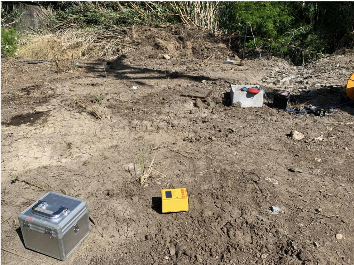
**Figura 55:** Foto relativa all'esecuzione della prova HVSr BH 22.
