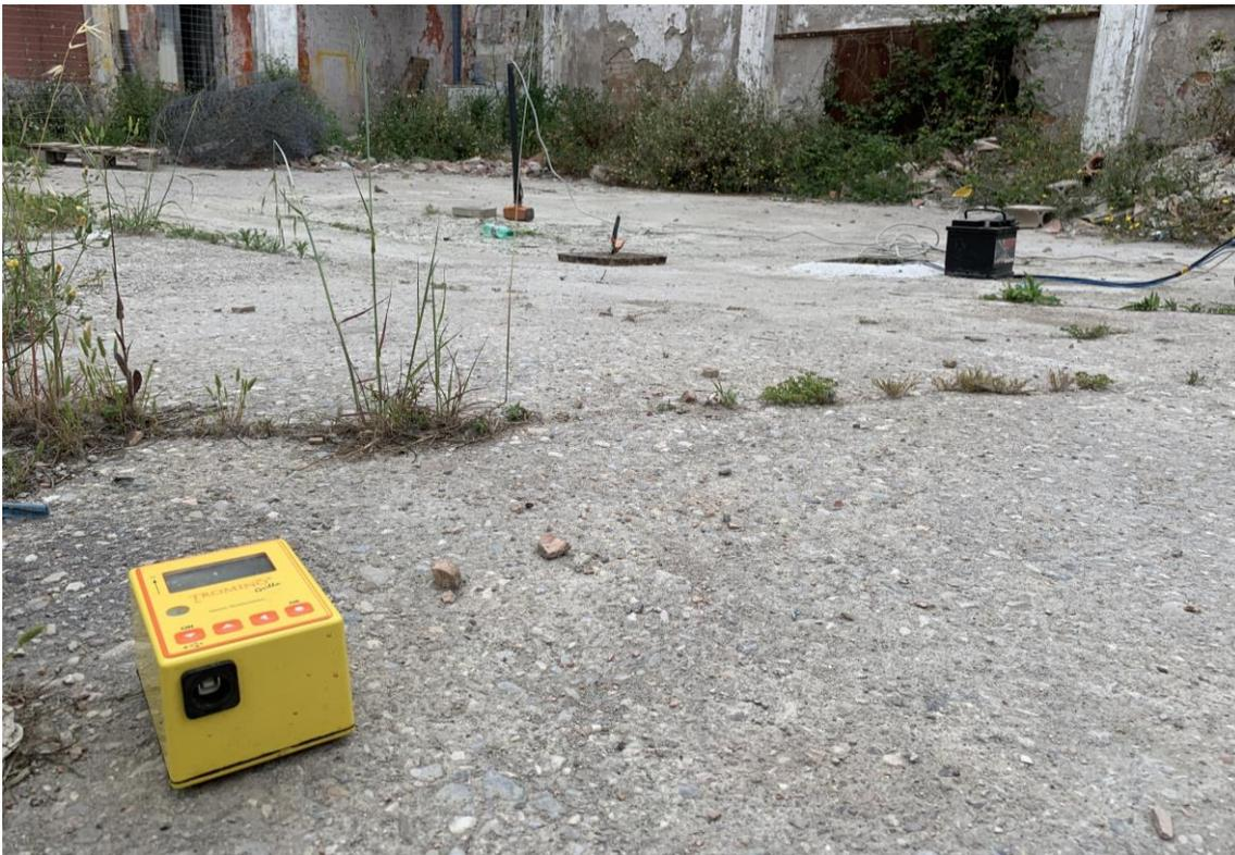
Figura 53: Foto relativa all'esecuzione della prova HVSr BH 12.
