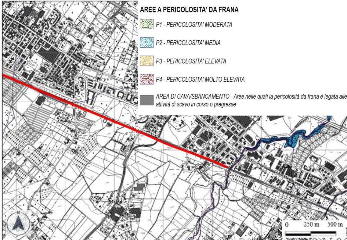
Figura 2-4 – Autorità di Bacino Destra Sele, Carta della Pericolosità da Frana in scala 1:5.000 (2011): stralcio non in scala della Tavola F_PRCL_467151. (In rosso parte del tracciato oggetto di studio).
