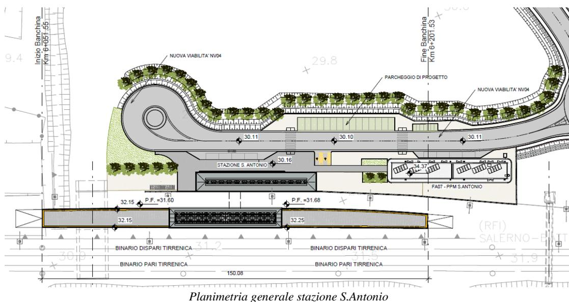
Alla fermata si accede da un piazzale in fregio al nuovo collegamento viario NV04, a doppio senso con loop (torna-indietro) finale. Una nuova rotondella e un'opera di scavalco del torrente Frestola consentono di collegare il piazzale della stazione alla viabilità e agli abitati esistenti anche ad ovest della fermata, oltre che ad est. Il tutto come definito e descritto negli elaborati specifici, dove vengono descritti vincoli e soluzioni adottate.
