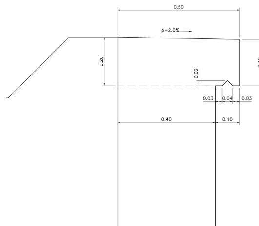
Sezione Muro di sottoscarpa Tipo 2
