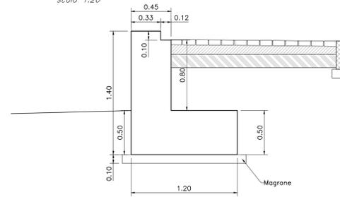
Dettaglio carpenteria testa muro
