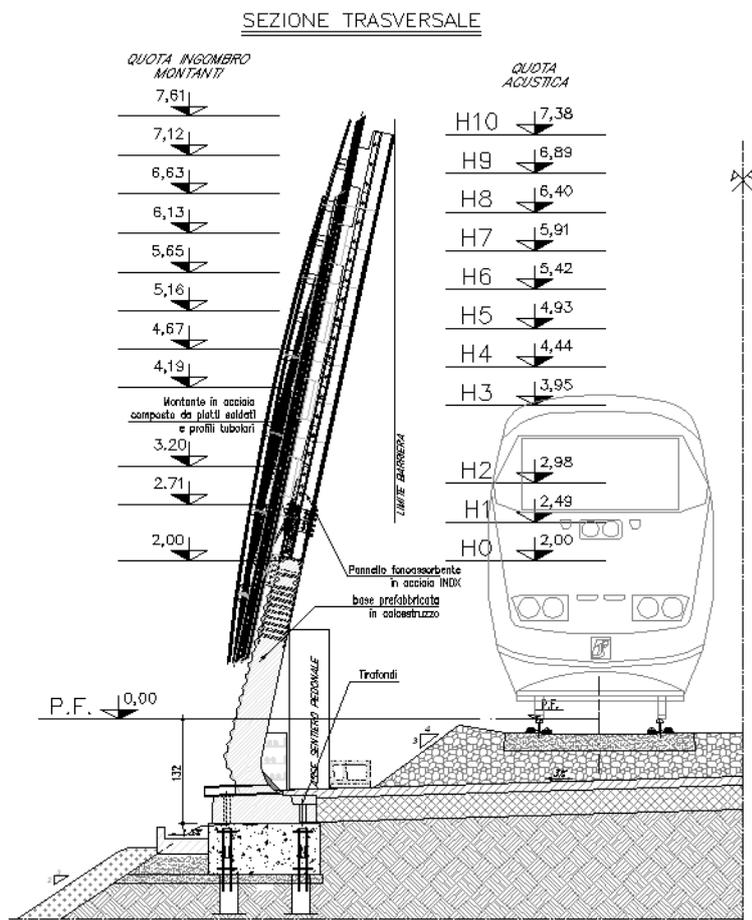
Figura 1 – Sezione tipo barriera antirumore su rilevato.
