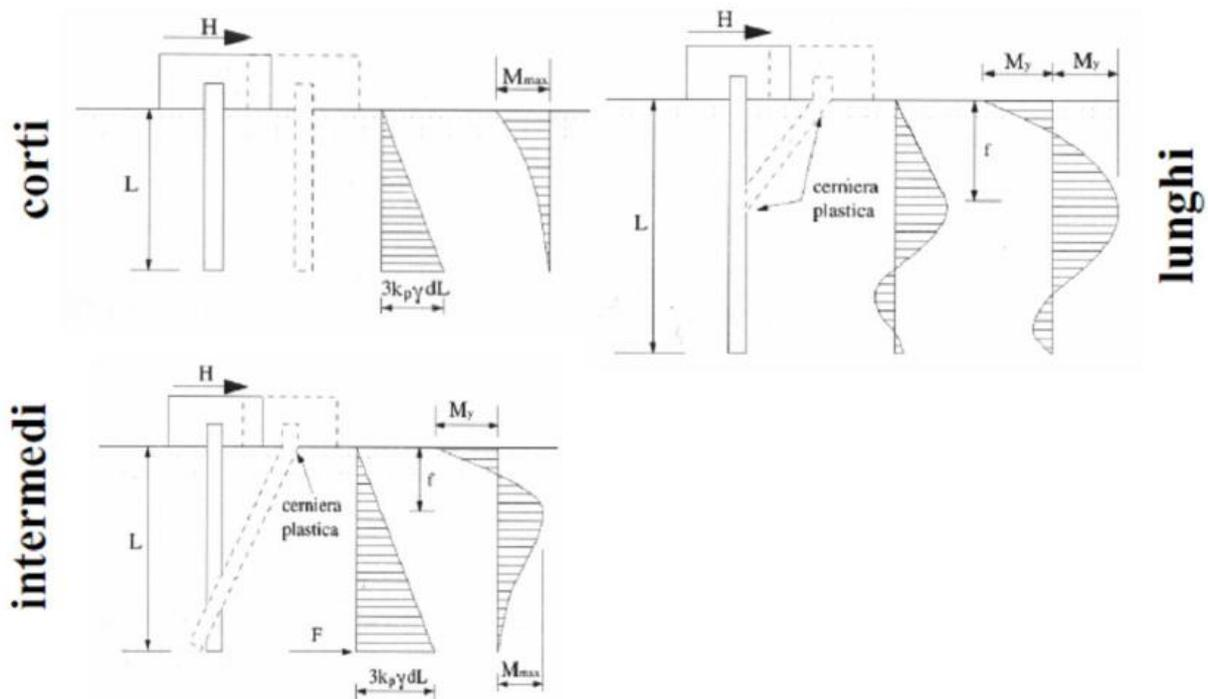
Figura 4: Carico limite trasversale: terreni incoerenti
