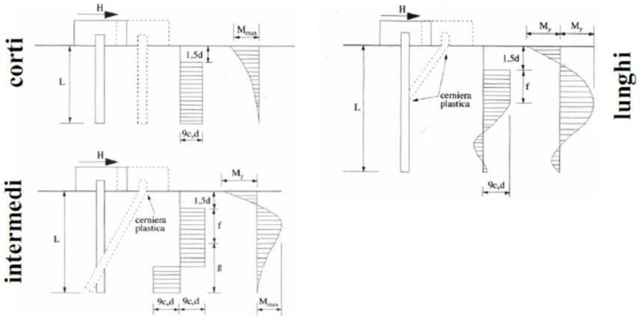
Figura 3: Carico limite trasversale: terreni coesivi
