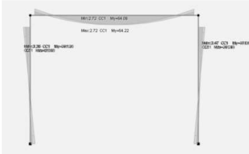
Figura 7.1-5 Diagramma dei momenti M3 - COMB_INV_SLV – Telaio interno
